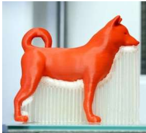
Obrázek 13: 3D tištěný objekt (metodou FDM) s vertikální podporou [35].
