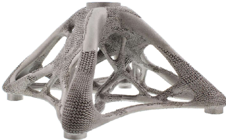
Obrázek 18: Architektonický „pavouk“, výroba tiskárnou Renishaw AM250 z titanu [24].
