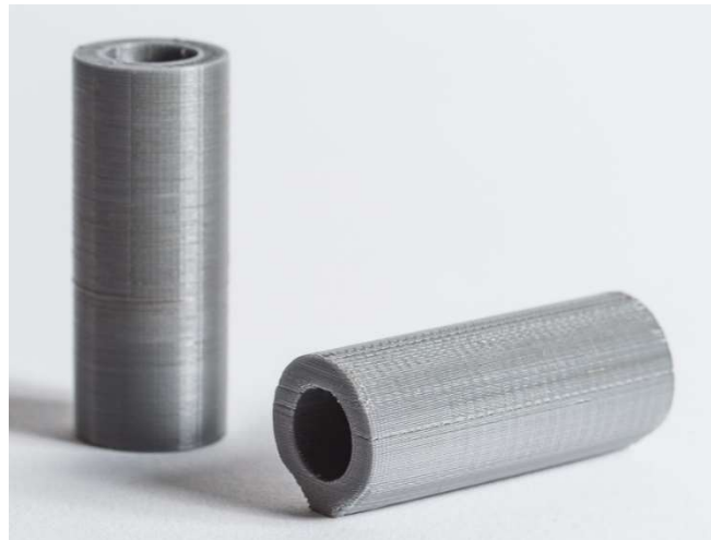
Obrázek 22: Válec tištěný vertikálně (vlevo) a horizontálně (vpravo) [31].
