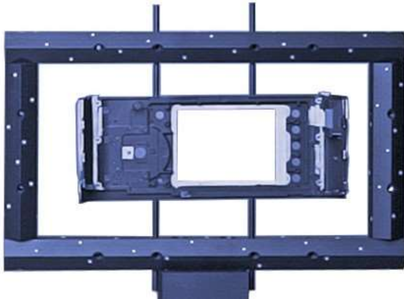
Obrázek 28: Plastový díl s upínacím rámem.
