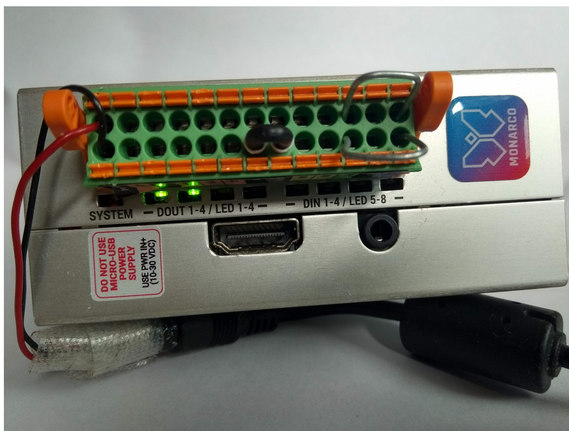
Obrázek 8: Raspberry Pi + Monarco HAT s připojenými vstupy/výstupy
