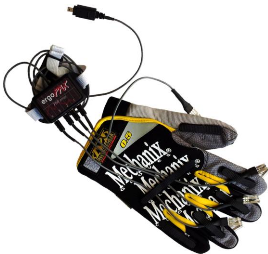
Obrázek 2.10 ergoPak FSR připojené do rozbočovače a uložené v rukavici ergoGLOVE
