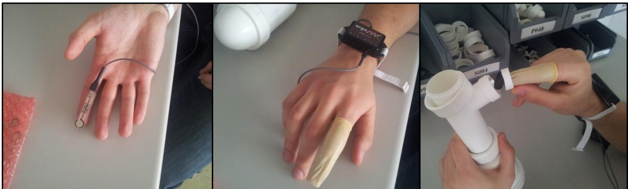
Obrázek 4.8 Zapojení a upevnění senzoru ergoPAK FSR a měření 5 s jeho využitím
