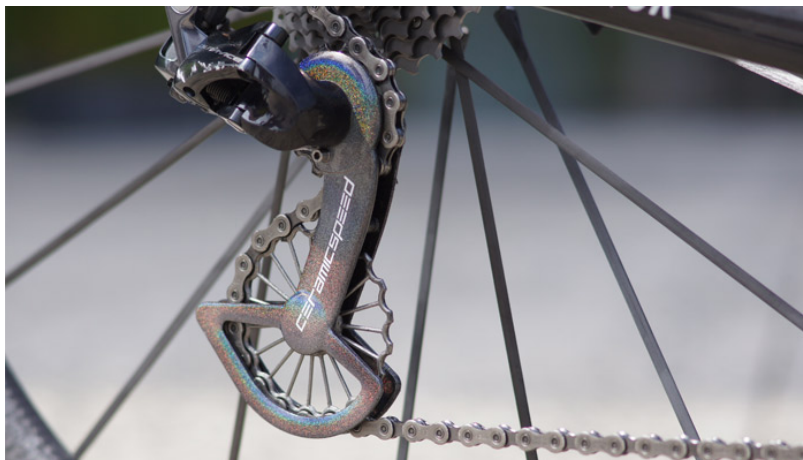
Obr. 4 Kladka v přehazovačce vyrobená AM (7)
