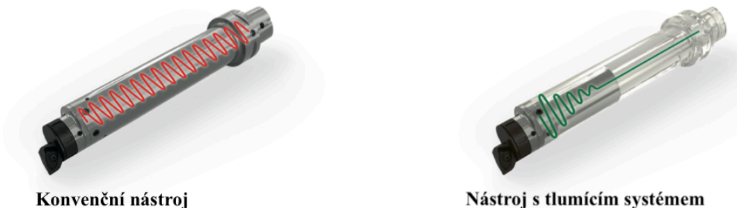
Obr. 36 Účinek tlumícího systému (30)
