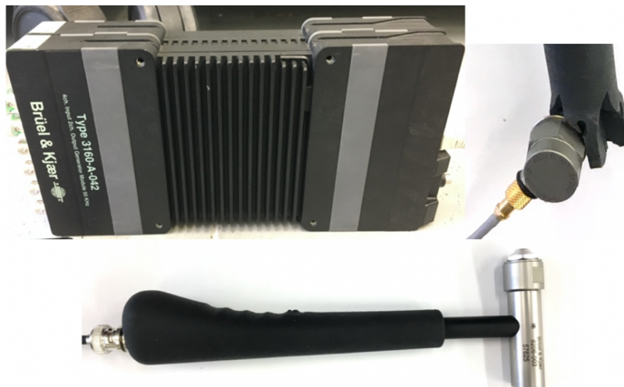
Obr. 49 Aparatura pro měření modální analýzy fréz
