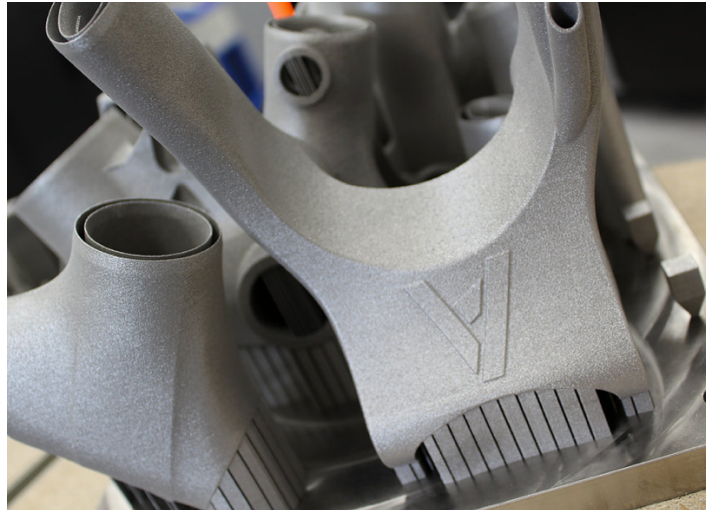
Obr. 2 Části rámu Atherton Bikes vyrobené AM (2)
