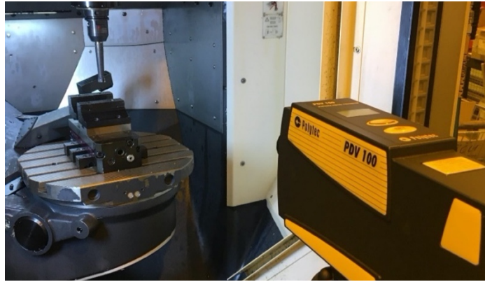
Obr. 52 Vibrometr Polytec PDV 100
