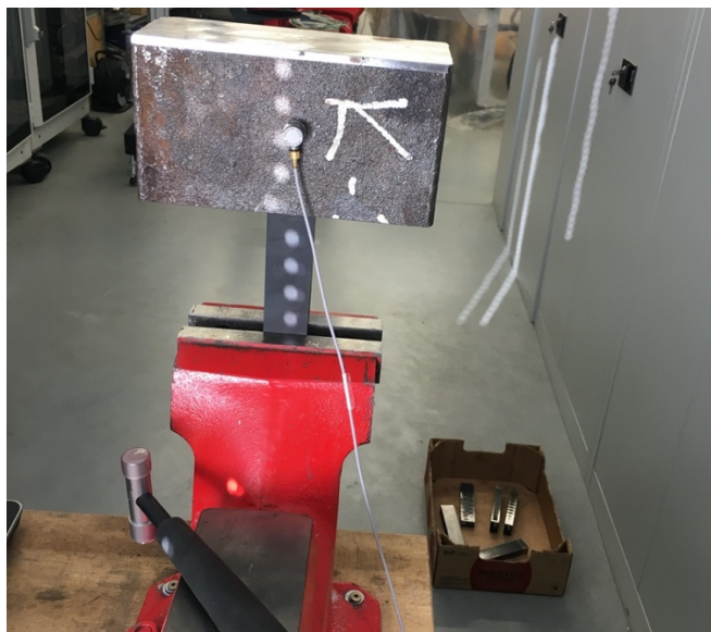
Obr. 51 Upevnění vzorku při měření tlumících charakteristik
