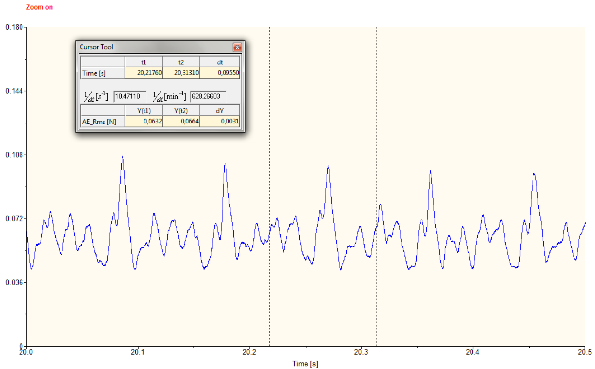
Graf 13: Vertikální frézování při a_p = 1 \text{ mm} , n_f = 630 \text{ ot/min} , časový úsek 20-20,5 s
