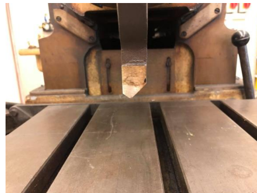
Obrázek 30: Detail použitého hoblovacího nože (Zdroj: VLASTNÍ)
