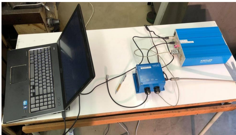
Obrázek 16: Použitý měřicí systém pro detekci akustické emise (Zdroj: VLASTNÍ)
