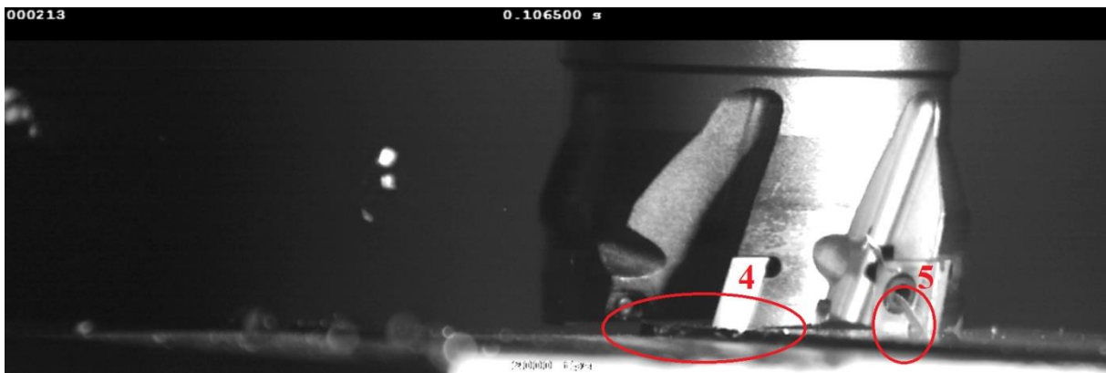
Obrázek 45: Vertikální frézování při a_p = 1 \text{ mm} , n_f = 630 \text{ ot/min} - destička 4 a 5 (Zdroj: VLASTNÍ)
