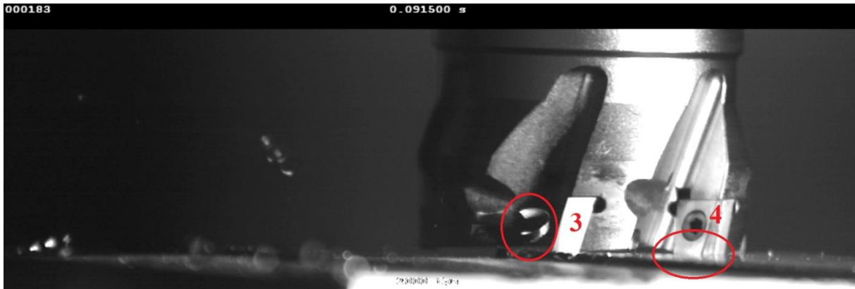
Obrázek 44: Vertikální frézování při a_p = 1 \text{ mm} , n_f = 630 \text{ ot/min} - destička 3 a 4 (Zdroj: VLASTNÍ)
