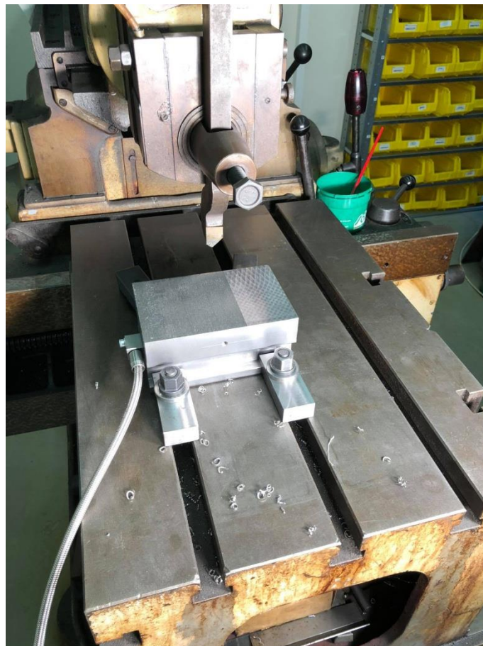
Obrázek 28: Upnutí obrobku na pracovní stůl horizontální obrázečky STRIGON GH 560/U pomocí upínek a montáž snímače akustické emise (Zdroj: VLASTNÍ)
