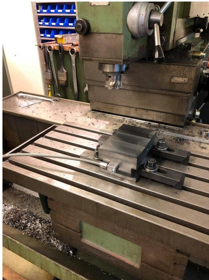
Obrázek 37: Upnutí obrobku na pracovní stůl vertikální frézky TOS FNGJ 20 pomocí upínek a montáž snímače akustické emise (Zdroj: VLASTNÍ)
