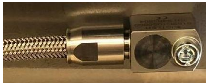
Obrázek 17: Piezoelektrický snímač AE (Zdroj: VLASTNÍ)
