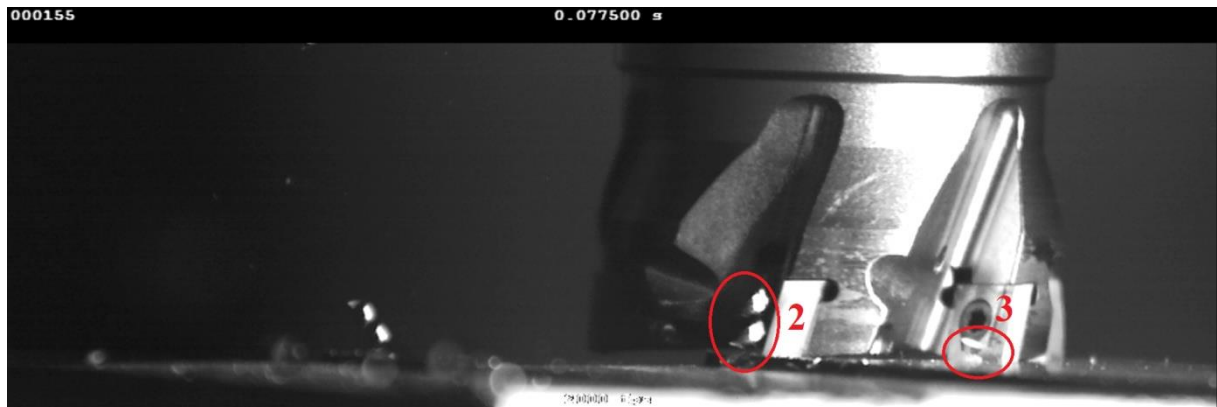
Obrázek 43: Vertikální frézování při a_p = 1 \text{ mm} , n_f = 630 \text{ ot/min} - destička 2 a 3 (Zdroj: VLASTNÍ)
