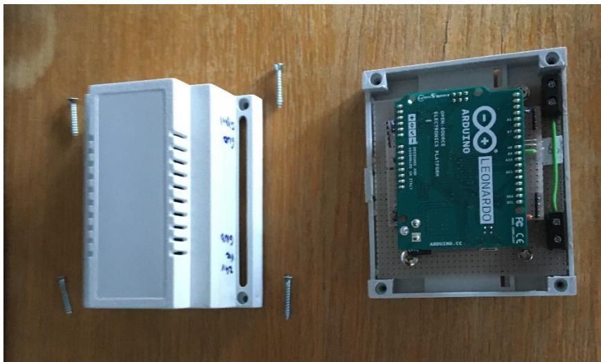
Obr. 5-14 Arduino umístěné v krabičce na lištu DIN [zdroj: autor]
