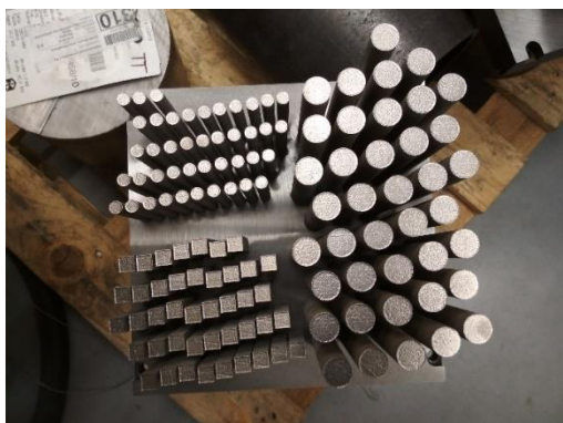
Obr. 14 Platforma s vytisknutými polotovary z oceli MS1
