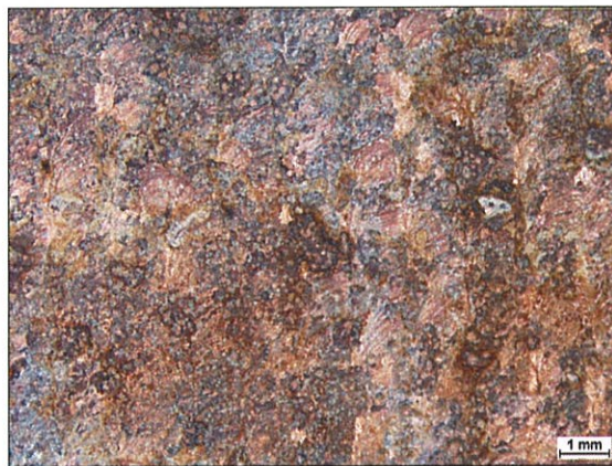
Obrázek 5-71 Povrch kompozitního návaru po expozici kyselinou akrylátovou inhibovanou, zv. 10x
