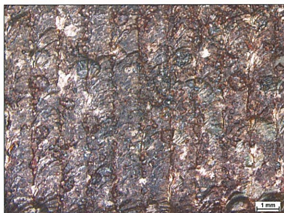
Obrázek 5-60 Povrch kompozitního návaru před expozicí kyselinou buthyl-akrylátovou, zv. 10x
