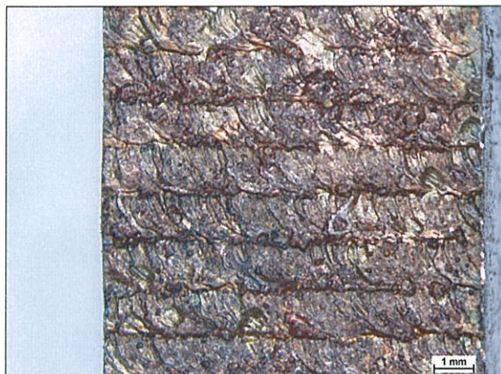
Obrázek 5-64 Povrch kompozitního návaru před expozicí kyselinou ethylhexylakrylátovou, zv. 10x
