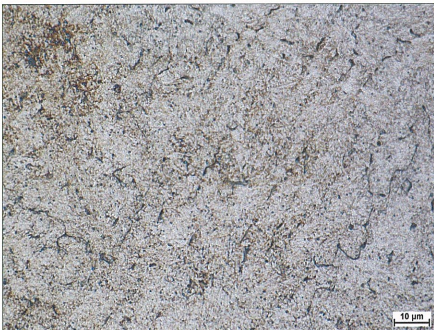
Obrázek 8-126: Mikrostruktura kompozitního návaru, zv. 100Ox, leptáno: Robin
