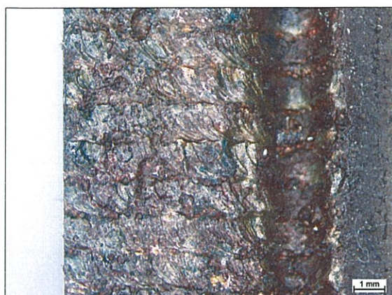
Obrázek 5-76 Povrch kompozitního návaru před expozicí kyselinou ethylakrylátovou, zv. 10x
