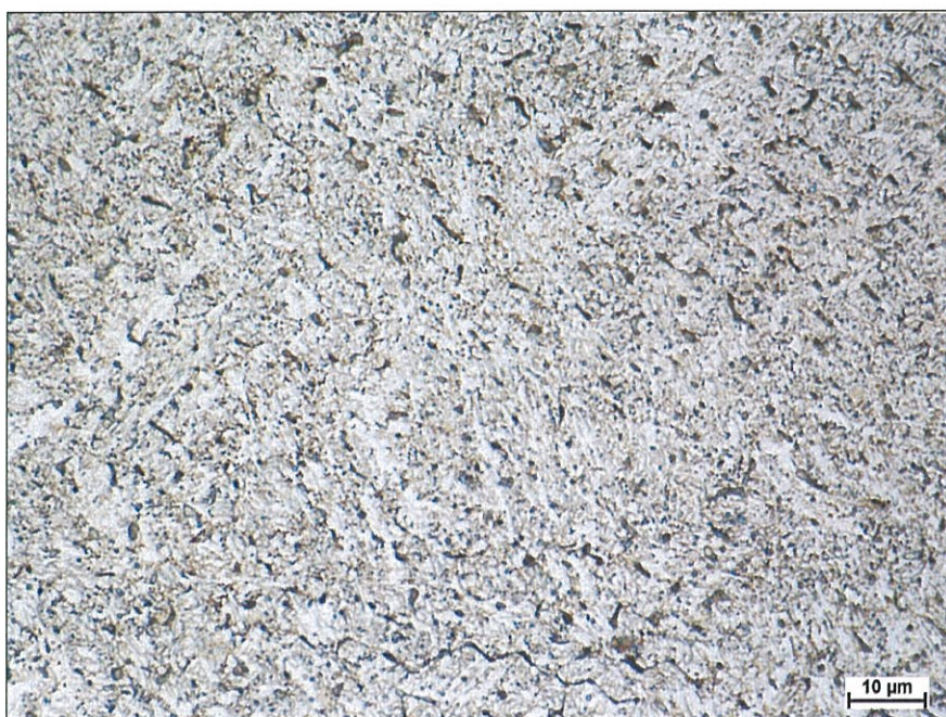
Obrázek 8-147: Mikrostruktura kompozitního návaru, zv. 100Ox, leptáno: Robin
