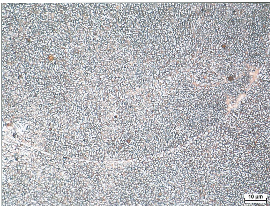
Obrázek 8-140: Mikrostruktura kompozitního návaru, zv. 100Ox, leptáno: Robin
