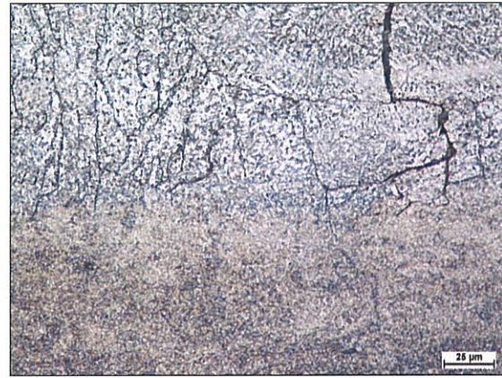
Obrázek 4-19 Přechod mezi substrátem a první housenkou u vzorku 2, zv. 500x, leptáno: Robin
