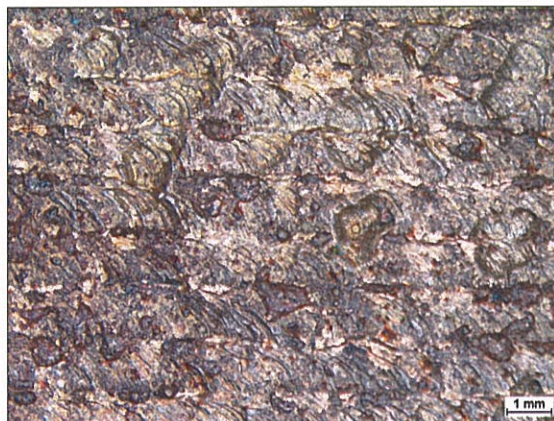
Obrázek 5-81 Povrch kompozitního návaru po expozici kyselinou methylakrylátovou, zv. 10x
