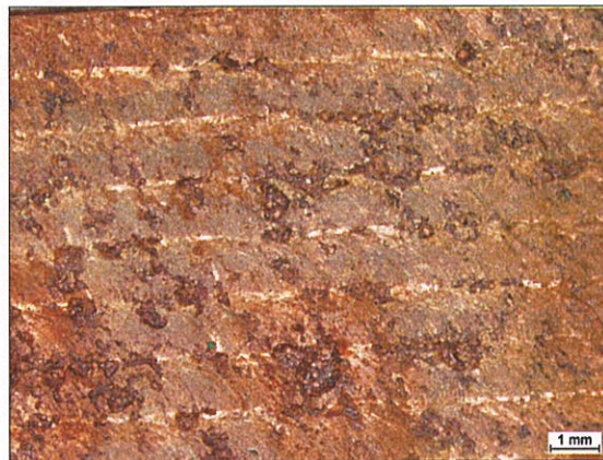
Obrázek 5-85 Povrch kompozitního návaru po expozici čistou kyselinou akrylátovou, zv. 10x
