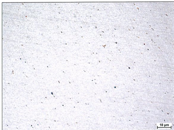
Obrázek 4-22 Znázornění oblasti druhé housenky v nenaleptaném stavu, zv. 1000x, neleptáno
