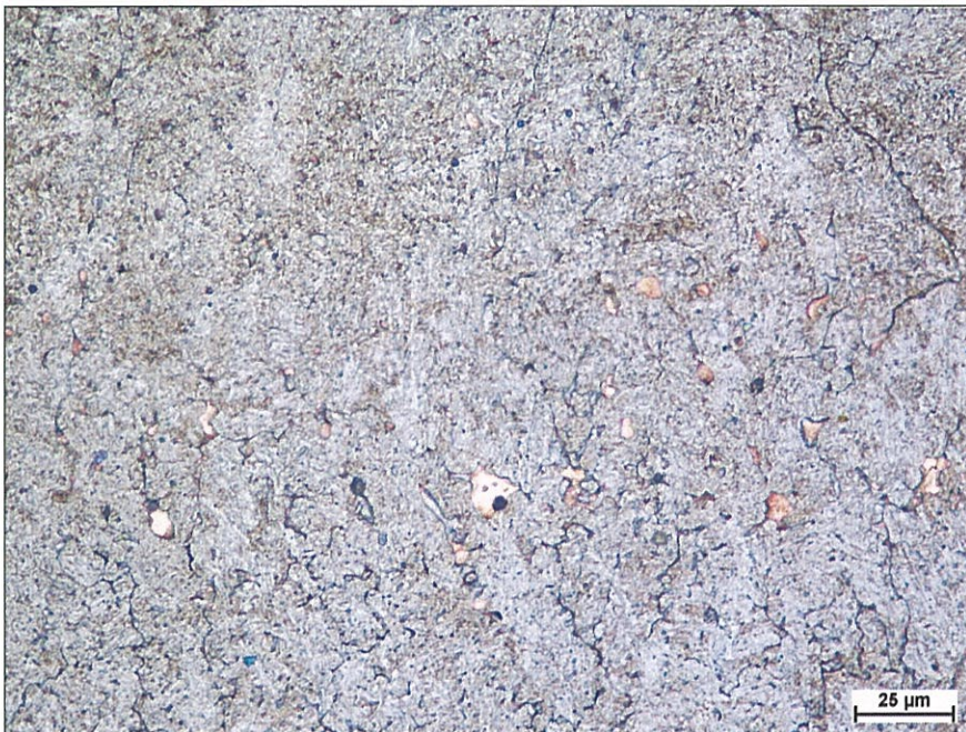
Obrázek 8-134: Mikrostruktura kompozitního návaru, zv. 50Ox, leptáno: Robin
