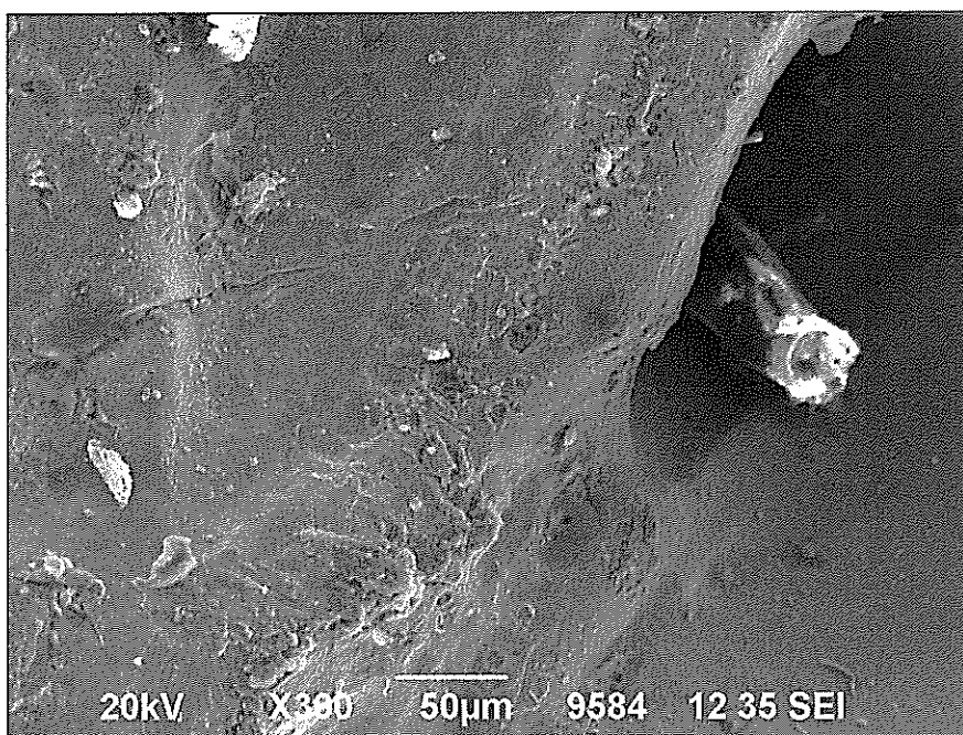
Obrázek 8-158: Povrch kompozitního návaru po korozní zkoušce, zv. 300x
