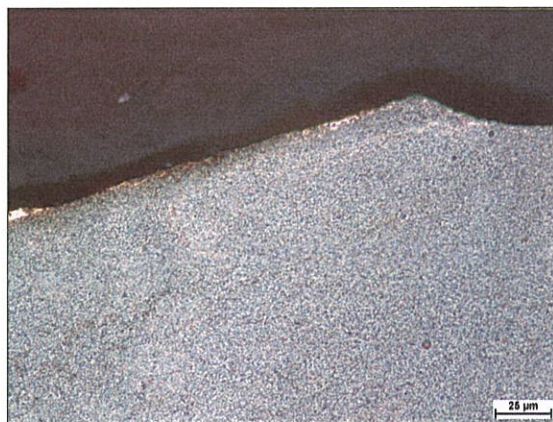
Obrázek 5-93 Mikrostruktura vzorku po expozici kyselinou Ethylakrylátovou, zv. 500x, leptáno: Robin
