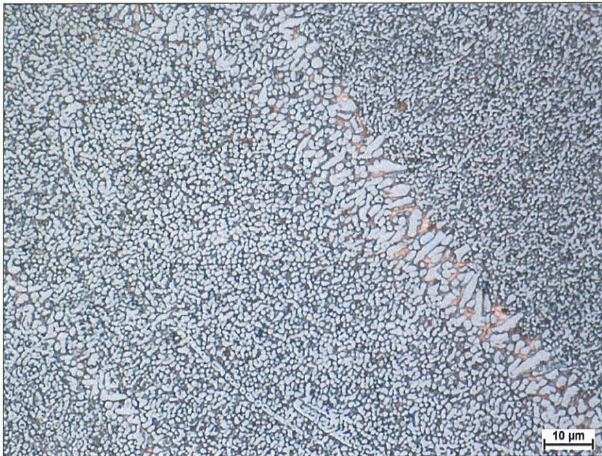
Obrázek 8-123: Mikrostruktura kompozitního návaru, zv. 100Ox, leptáno: Robin
