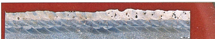
Obrázek 8-104: Makrostruktura vzorku 3, zv. 20x, leptáno: Robin
