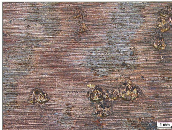
Obrázek 5-54 Zbroušený povrch kompozitního návaru po expozici kyselinou methylakrylátovou, zv. 10x
