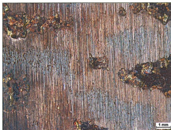
Obrázek 5-51 Zbroušený povrch kompozitního návaru po expozici kyselinou ethylakrylátovou, zv. 10x
