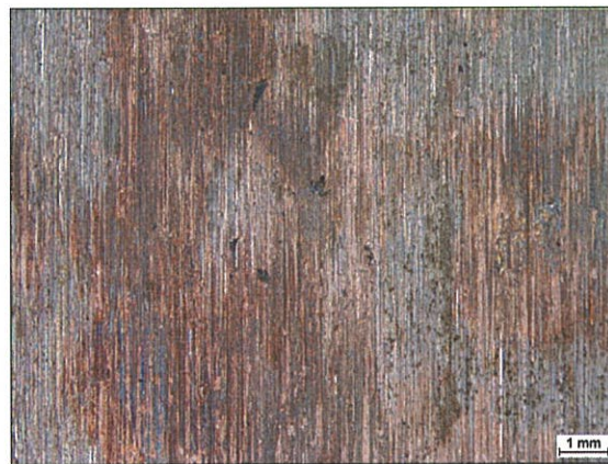
Obrázek 5-42 Zbroušený povrch kompozitního návaru po expozici kyselinou buthylakrylátovou, zv. 10x
