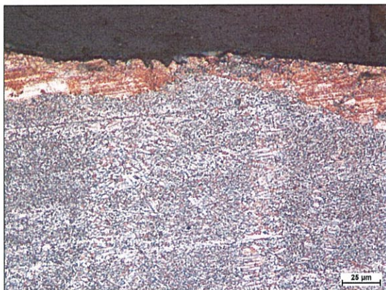
Obrázek 5-90 Mikrostruktura vzorku po expozici kyselinou Buthyl-akrylátovou, zv. 500x, leptáno: Robin
