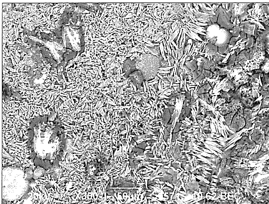
Obrázek 8-151: Povrch kompozitního návaru po korozní zkoušce, zv. 300x, odražené elektrony
