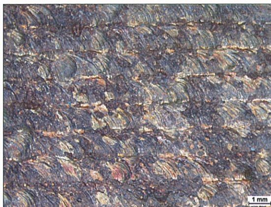
Obrázek 5-61 Povrch kompozitního návaru po expozici kyselinou buthyl-akrylátovou, zv. 10x
