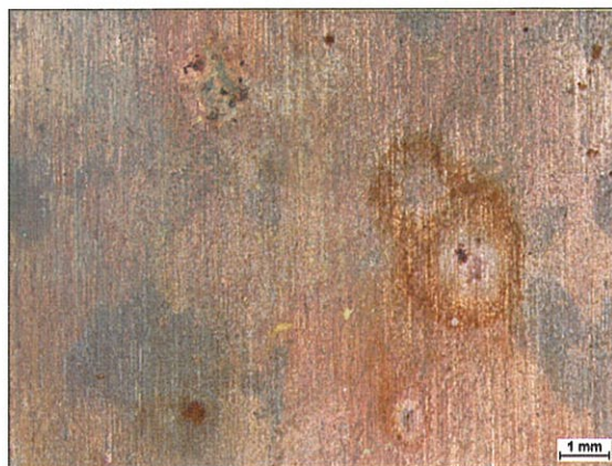
Obrázek 5-57 Zbroušený povrch kompozitního návaru po expozici čistou kyselinou akrylátovou, zv. 10x
