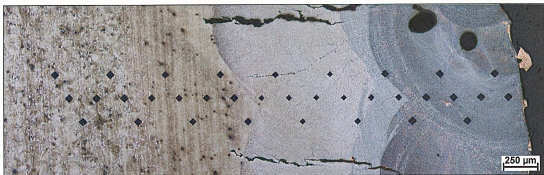
Obrázek 4-32: Vtisky HV0,5 od povrchu návaru k substrátu, 100x, leptáno: Robin
