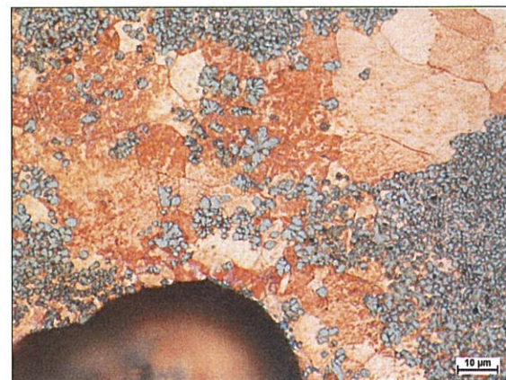
Obrázek 4-29 Pohled na zrna mědi vyskytující se v blízkosti pórů, zv. 1000x, leptáno: Robin
