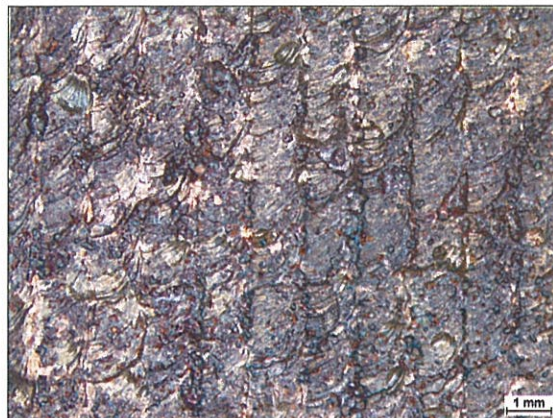
Obrázek 5-65 Povrch kompozitního návaru po expozici kyselinou ethylhexylakrylátovou, zv. 10x
