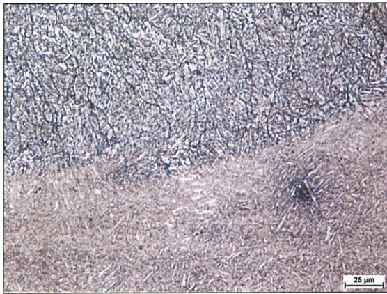
Obrázek 4-18 Přechod mezi substrátem a první housenkou u vzorku 1, zv. 500x, leptáno: Robin
