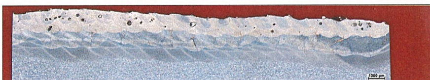
Obrázek 8-105: Makrostruktura vzorku 4, zv. 20x, leptáno: Robin
