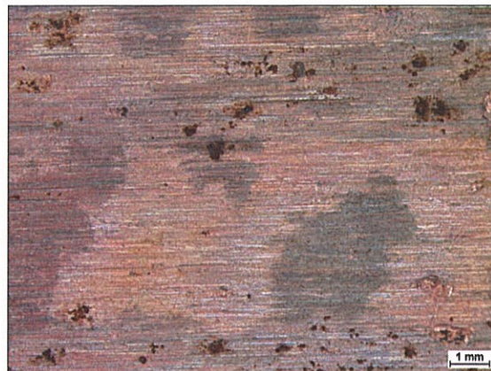
Obrázek 5-48 Zbroušený povrch kompozitního návaru po expozici kyselinou akrylátovou inhibovanou, zv. 10x
