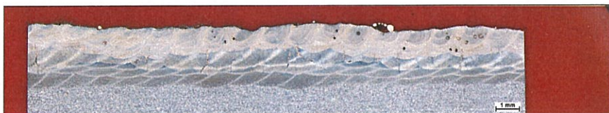
Obrázek 8-103: Makrostruktura vzorku 2, zv. 20x, leptáno: Robin
