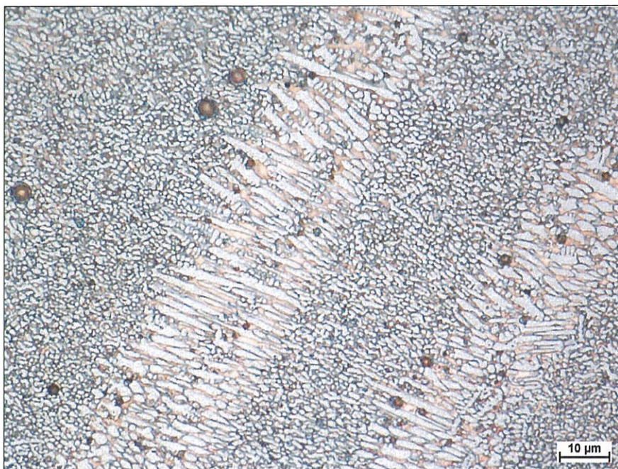
Obrázek 8-139: Mikrostruktura kompozitního návaru, zv. 100Ox, leptáno: Robin
