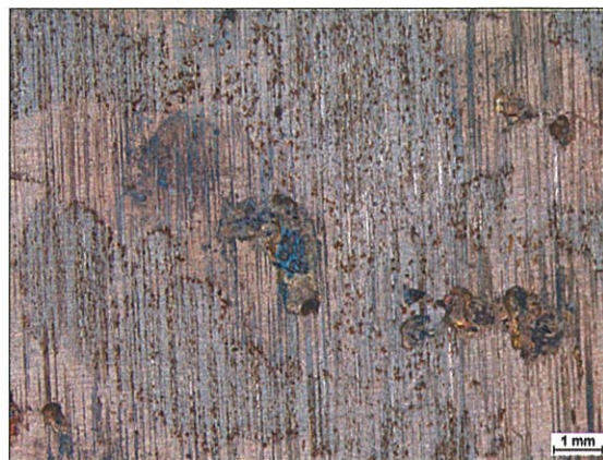
Obrázek 5-45 Zbroušený povrch kompozitního návaru po expozici kyselinou ethyl-hexyl-akrylátovou, zv. 10x
