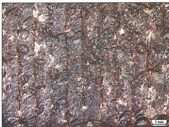
Obrázek 5-80 Povrch kompozitního návaru před expozicí kyselinou methylakrylátovou, zv. 10x
