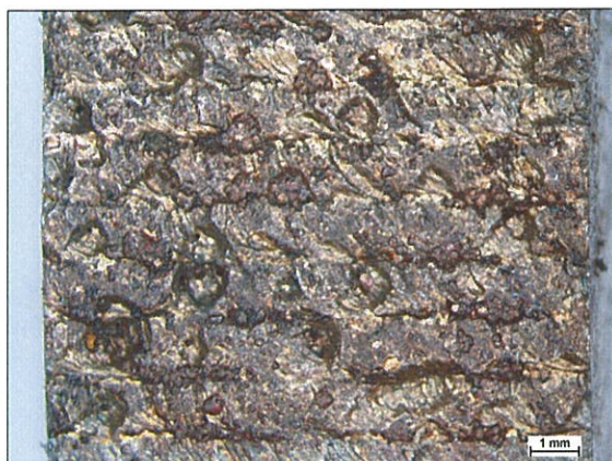
Obrázek 5-70 Povrch kompozitního návaru před expozicí kyselinou akrylátovou inhibovanou, zv. 10x
