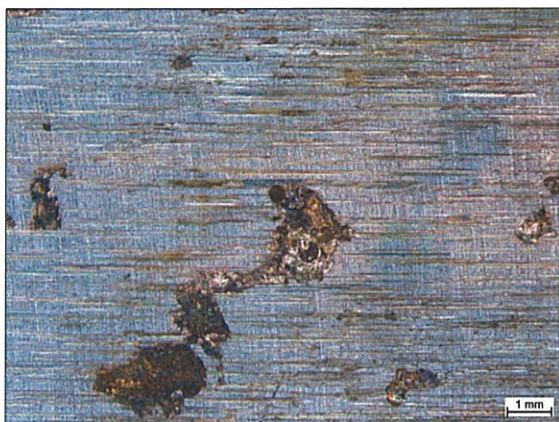
Obrázek 5-44 Zbroušený povrch kompozitního návaru před expozicí kyselinou ethyl-hexyl-akrylátovou, zv. 10x
