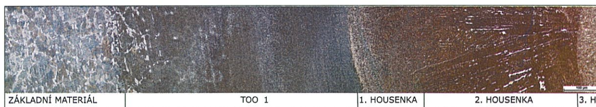
Obrázek 4-13: Změna mikrostruktury základního materiálu v závislosti vzdálenosti od hranice první navařené housenky, zv. 500x, leptáno: Nital
