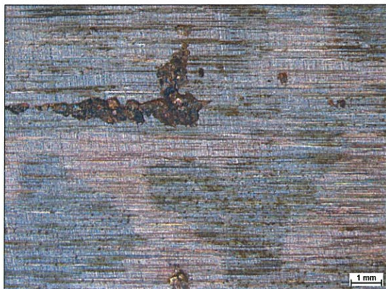
Obrázek 5-47 Zbroušený povrch kompozitního návaru před expozicí kyselinou akrylátovou inhibovanou, zv. 10x
