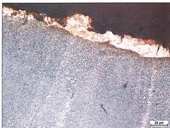
Obrázek 5-92 Mikrostruktura vzorku po expozici kyselinou Akrylátovou inhibovanou, zv. 500x, leptáno: Robin
