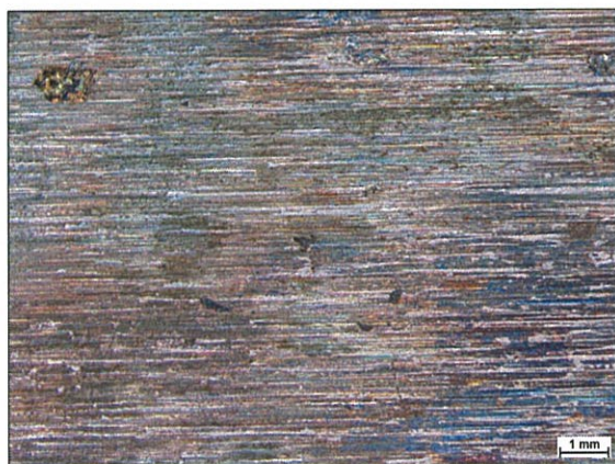
Obrázek 5-41 Zbroušený povrch kompozitního návaru před expozicí kyselinou buthylakrylátovou, zv. 10x
