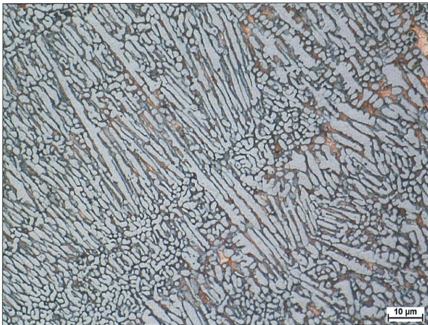
Obrázek 8-111: Mikrostruktura kompozitního návaru, zv. 100Ox, leptáno: Robin
