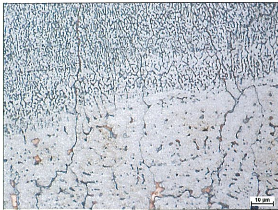
Obrázek 4-24 Změna mikrostruktury z planární na celulární, zv. 1000x, leptáno: Robin
