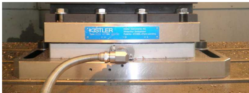
obr.4-8 Tří-složkový piezoelektrický dynamometr s připojeným kabelem
