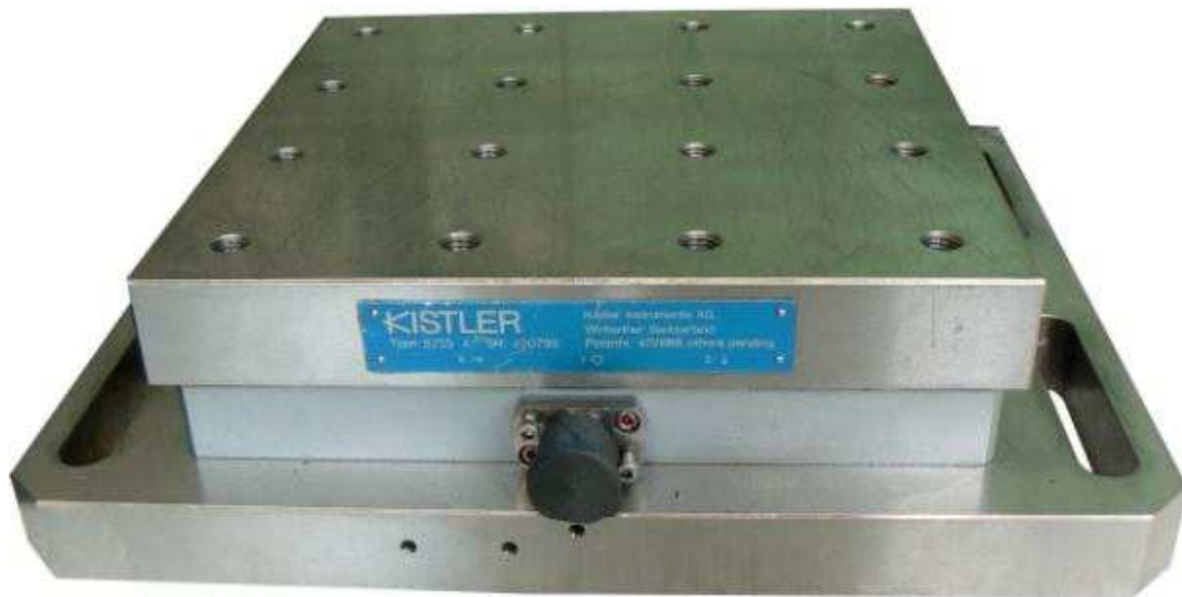
obr.P5 Třísložkový dynamometr Kistler 9255 A
