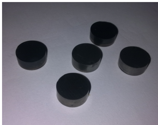
obr.4-4 Příklad cermetových kruhových VBD použitých pro experiment
