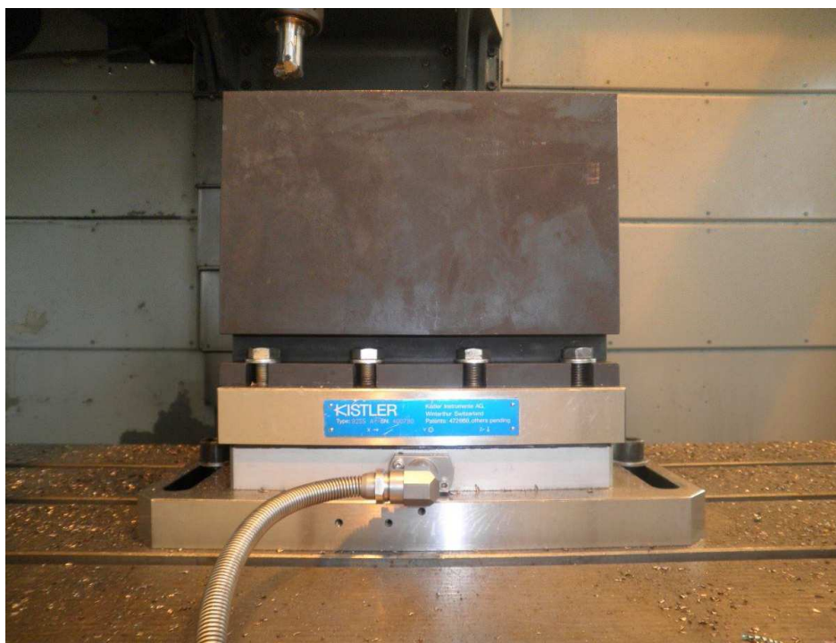
obr.P4 Materiál ČSN 19 436 upnutý na dynamometru
