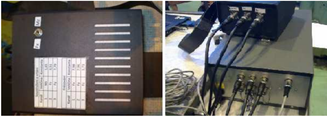
obr.4-10 Řadič a jeho propojení se zesilovačem
