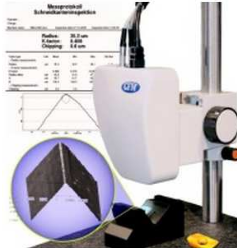
obr.4-16 Přístroj pro měření zaoblení řezné hrany MikroCAD Lite [16]
