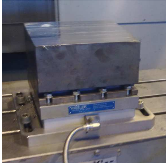
obr.4-6 Materiál ČSN 19 663 při experimentu před destrukcí upnutý na dynamometru
