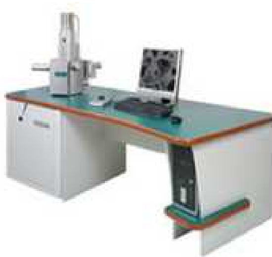
obr.4-19 Skenovací elektronový mikroskop TESCAN VEGA TS 5130 [16]
