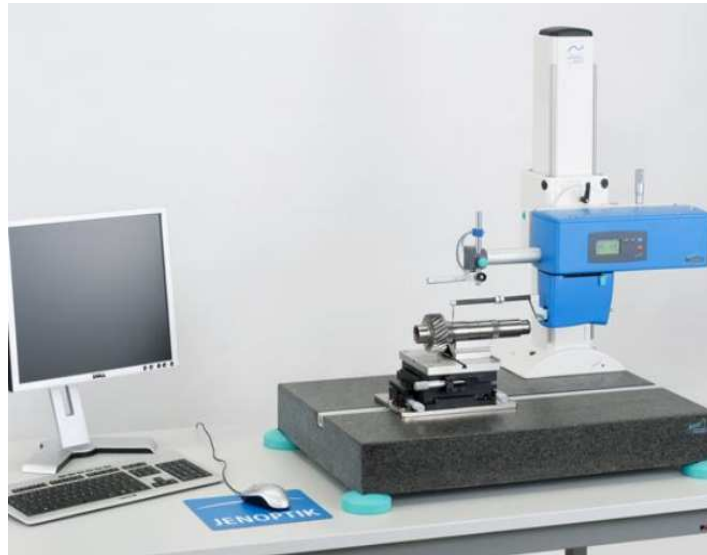
obr.4-18 Měřicí zařízení Hommel Etamic T8000 RC pro měření drsnosti [17]
