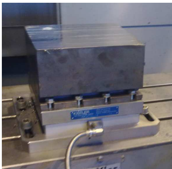
obr.P3 Materiál ČSN 19 663 upnutý na dynamometru
