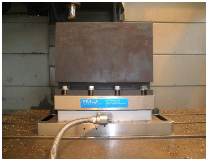
obr.4-7 Materiál ČSN 19 436 upnutý na dynamometru [10]
