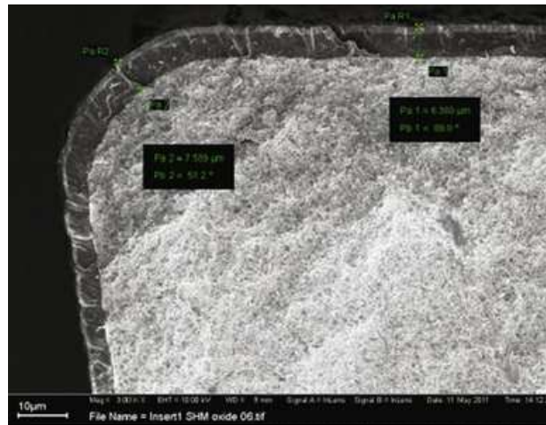
obr.3-3 Profil povlaku na břitě VBD naneseného pomocí metody PVD [20]
