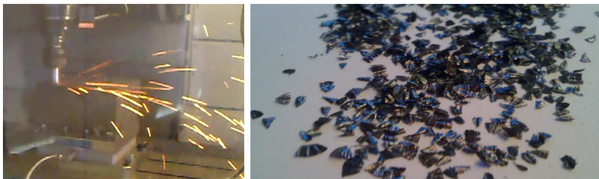
obr.5-3 Vznikající rozžhavané třísky (vlevo) a křehké třísky vznikající v průběhu experimentu
