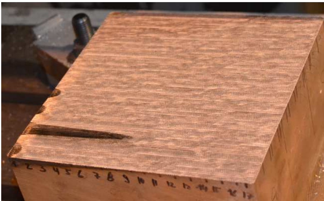
Obrázek 46 ukázka zakalených stop v prvním sloupci po odfrézování 1,6mm - první experiment
