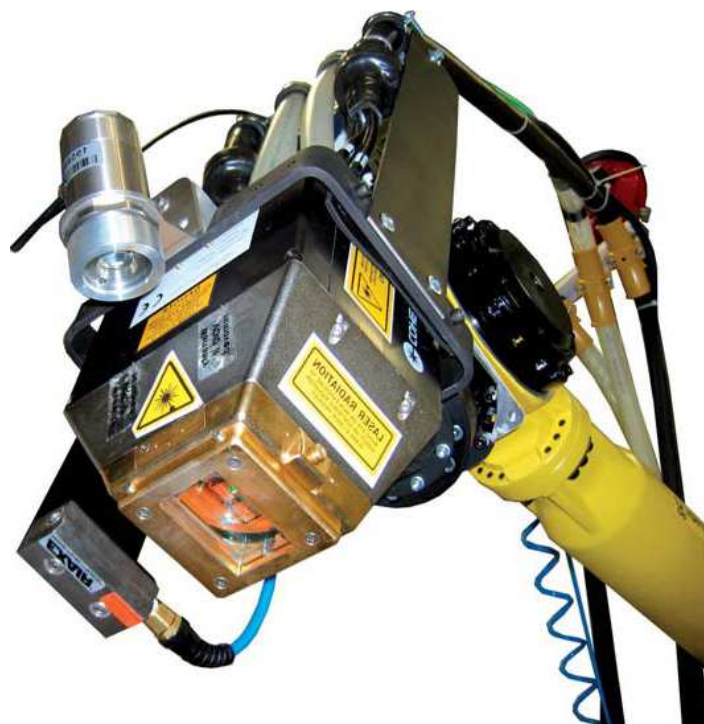
Obrázek 27 laserový systém HPDD Coherent ISL 4000L [16]
