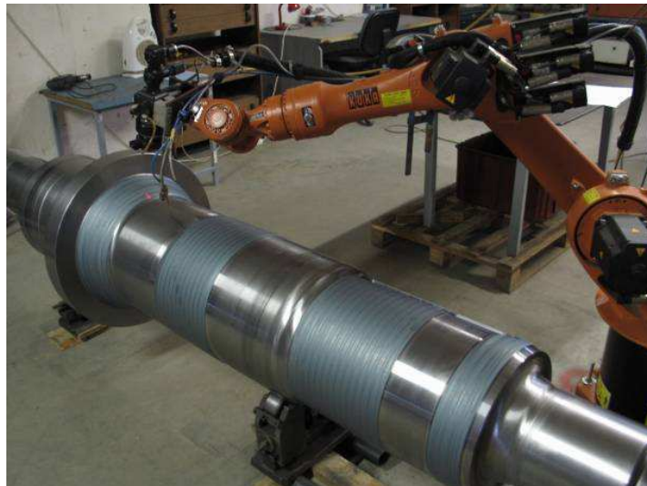
Obrázek 20 Kalení hřídelí velkých průměrů [14]
