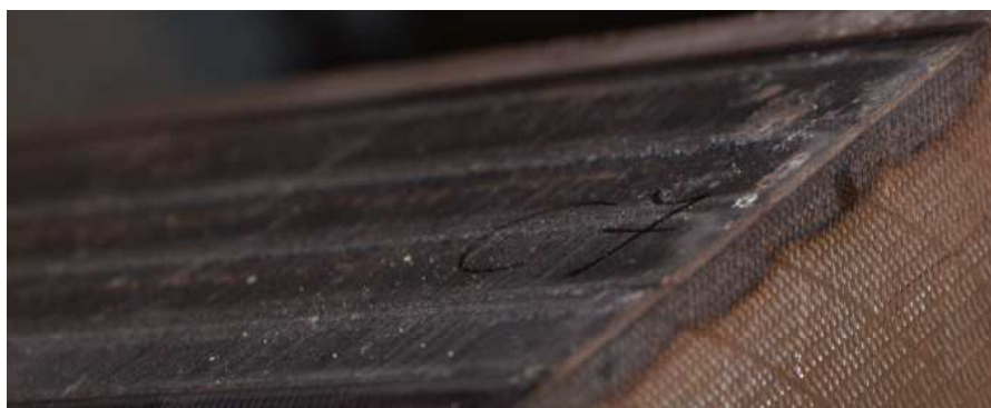
Obrázek 58 ukázka zakalených stop druhého experimentu
