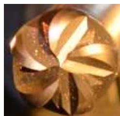
Obrázek 43 řezná část frézy OSG WXS-HS-CRE 12xR3
