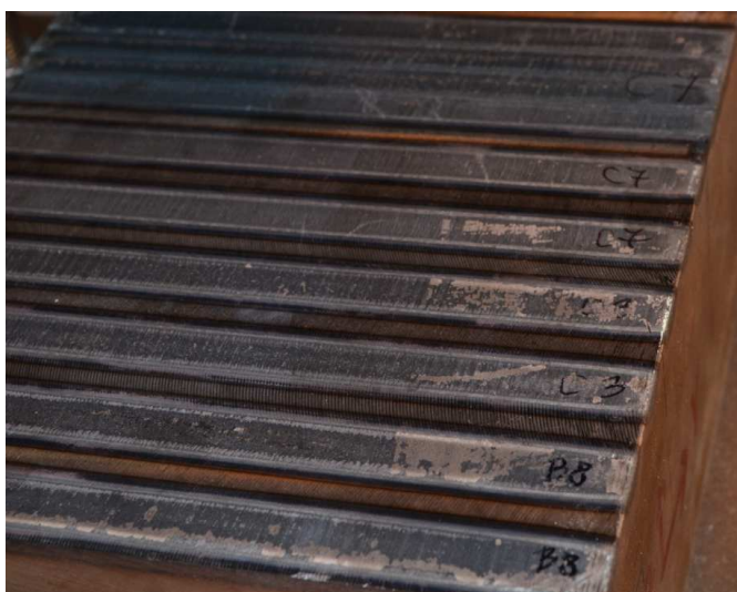
Obrázek 55 ukázka zakalených stop druhého experimentu
