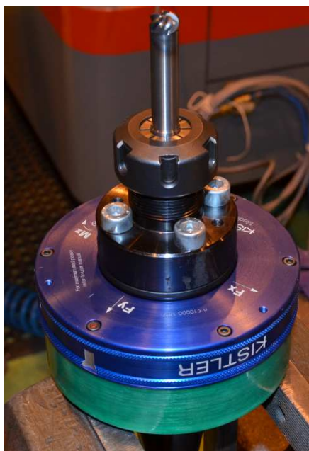
Obrázek 40 upnutí nástroje v rotačním dynamometru
