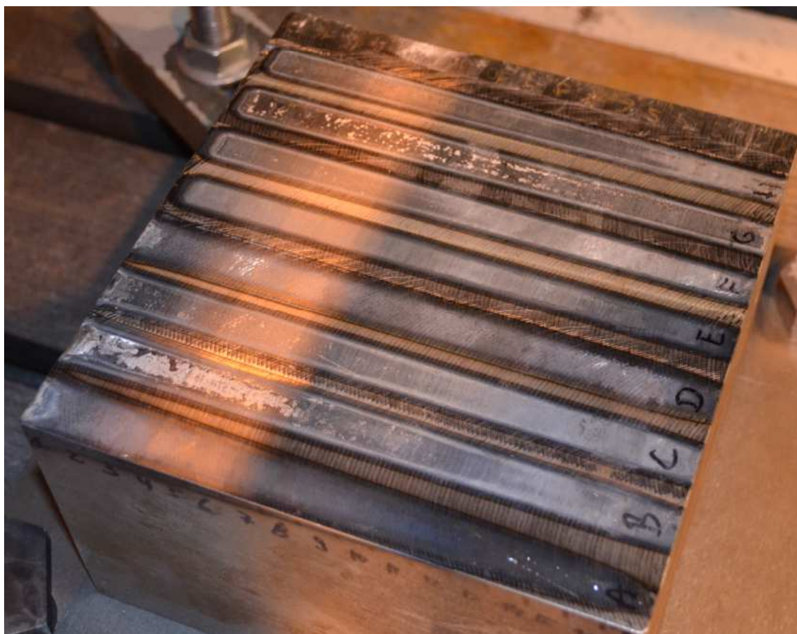
Obrázek 44 ukázka zakalených stop prvního experimentu
