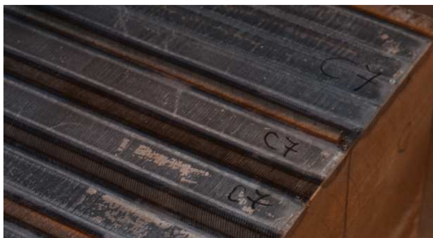
Obrázek 57 ukázka zakalených stop druhého experimentu
