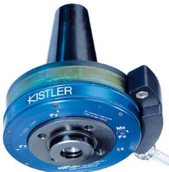
Obrázek 31 rotační dynamometr Kistler 9124B [20]
