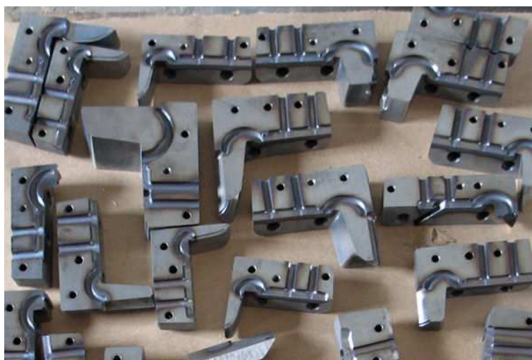
Obrázek 13 Formy na vstřikování plastů [14]
