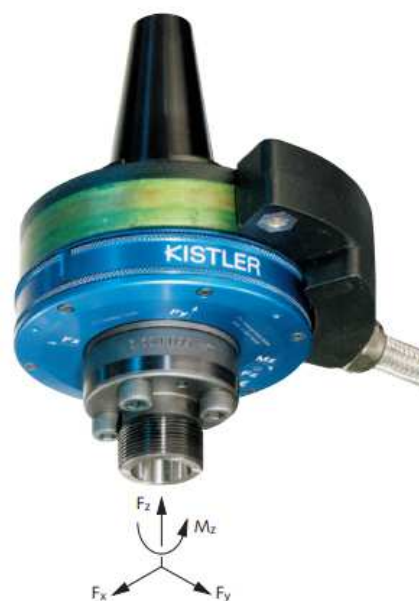
Obr. 22 Řezné síly na dynamometru
