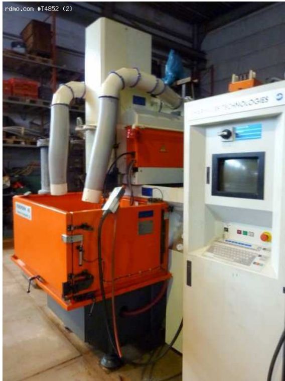
Obr. 3-16 – Elektroerozivní hloubička ROBOFORM 40
