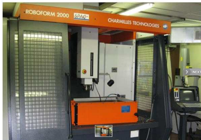
Obr. 4-6 - Elektroerozivní hloubička ROBOFORM 2000
