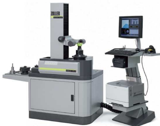
Obr. 3-5 – Naměřovací přístroj Zoller Venturion 450
