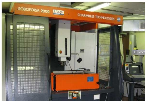
Obr. 3-17 - Elektroerozivní hloubička ROBOFORM 2000
