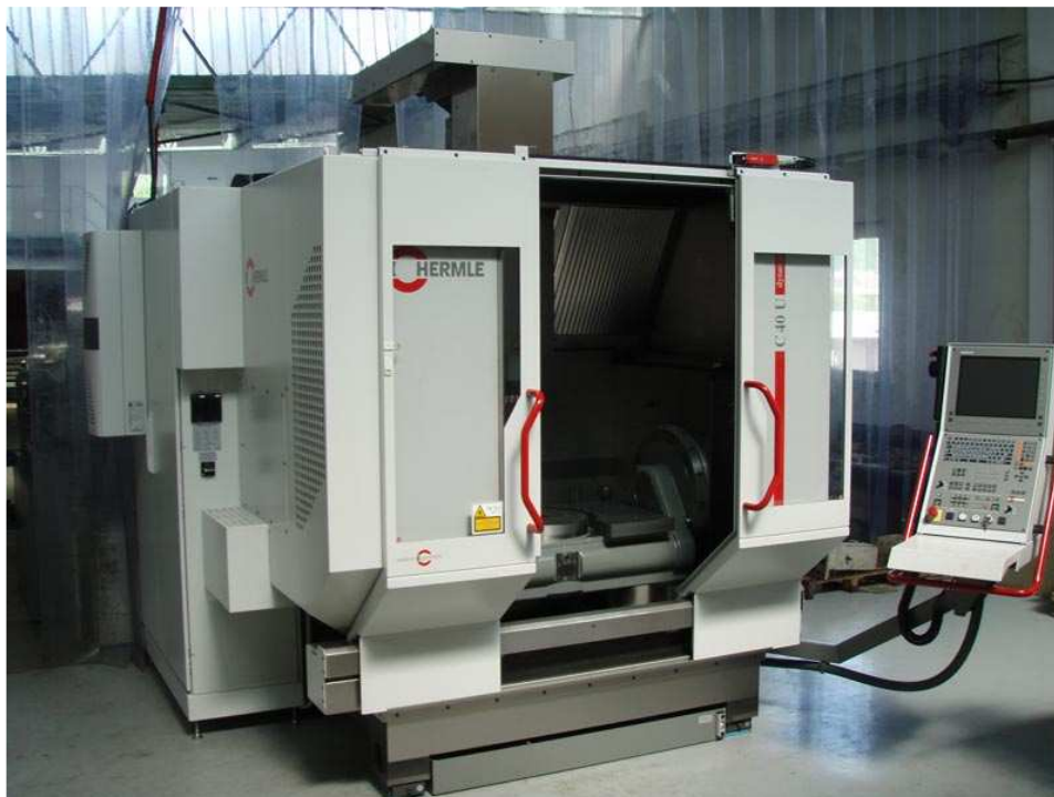
Obr. 3-3 – Vertikální obráběcí centrum Hermle C40U
