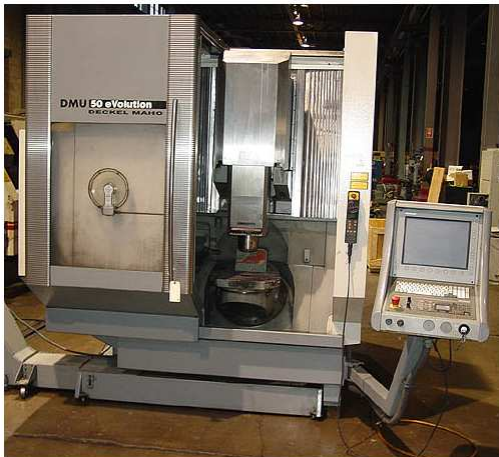
Obr. 3-4 – Vertikální obráběcí centrum DECKEL MAHO DMU 50 eVolution
