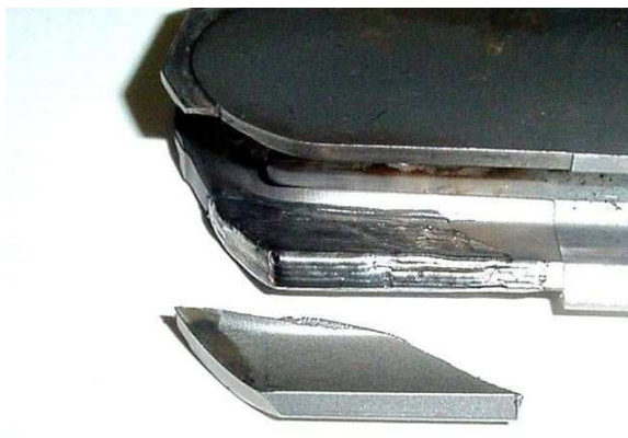
Obr. 1-1 – Oprava laserovým návarem
