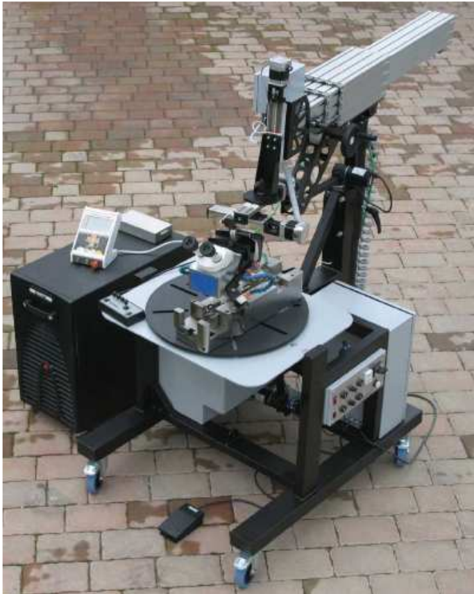
Obr. 4-2 - Laserový systém ACP02 od firmy MEPAC CZ
