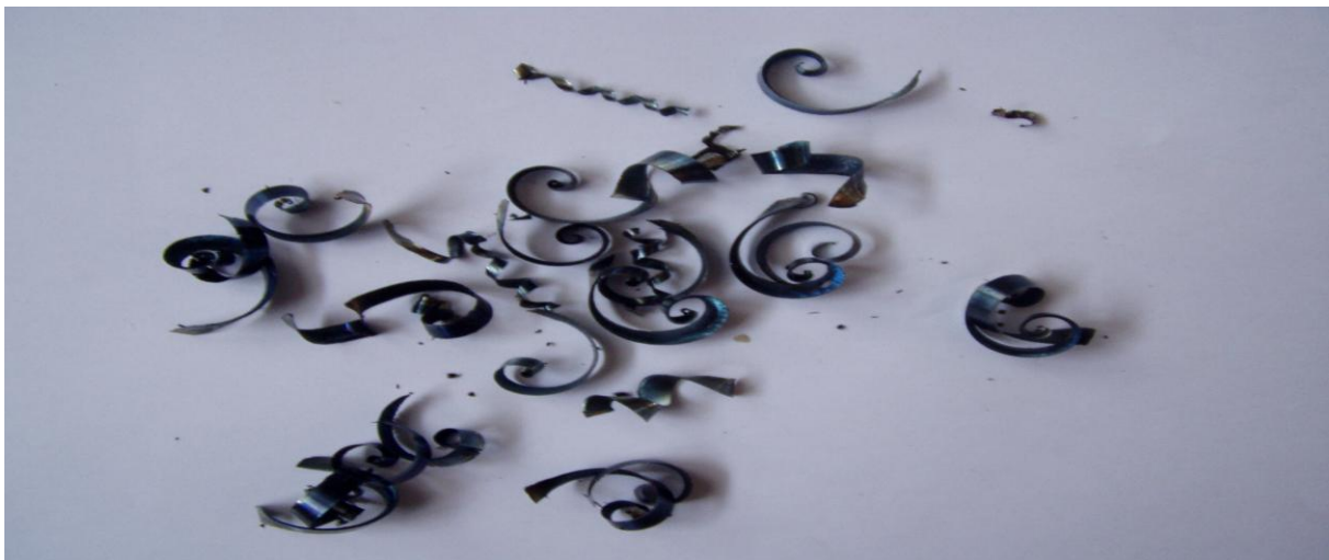
Obr. 7: Vhodný tvar třísky při obrábění (obloukovitě dělená tříska)
