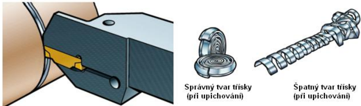
Obr. 15: Upnutí nástroje v obrácené poloze při upichování (zapichování) [31]
