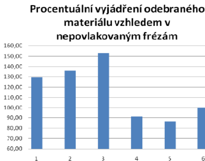
Graf 5.2 Relativní trvanlivost fréz s deponovanou tenkou vrstvou vůči frézám bez deponované vrstvy [5]
