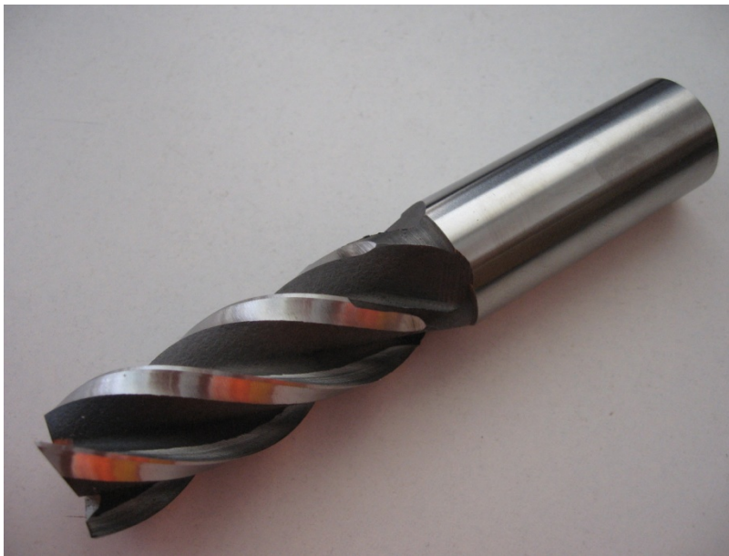
Obr. 4.2 Čelní válcová fréza Ø 20 mm se čtyřmi zuby ve šroubovici z materiálu 19 852
