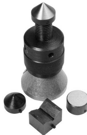
Obrázek 18 Univerzální podpěrka s hrotem dle ČSN 255548
