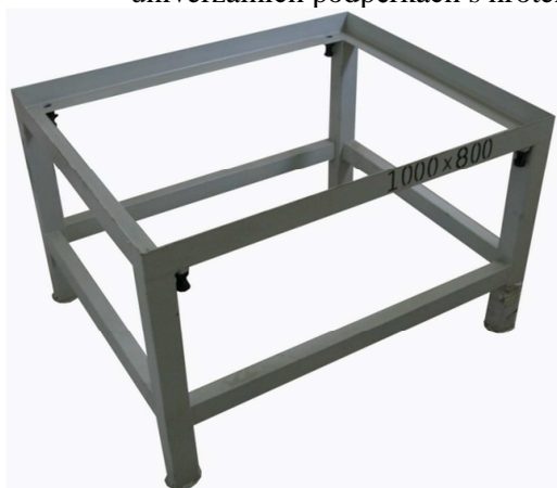
Obrázek 19 Stůl pro ustavení příměrné litinové desky
