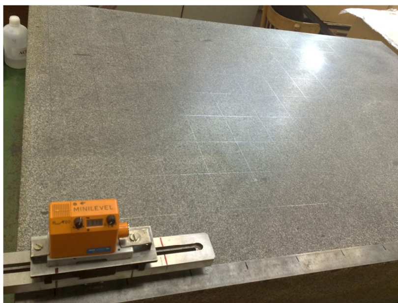
Obrázek 9 Orýsovaná granitová průměrná deska s měřicí libelou
