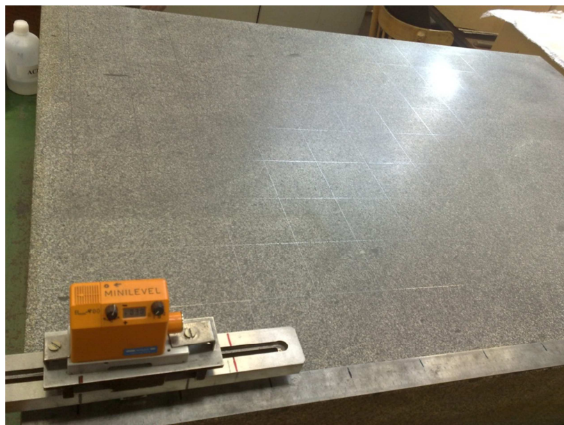
Obrázek 23 Orýsovaná granitová průměrná deska s měřicí libelou
