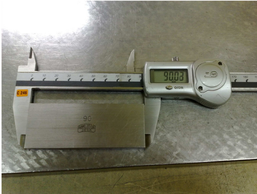
Obrázek 13 Kalibrace digitálního posuvného měřítka
