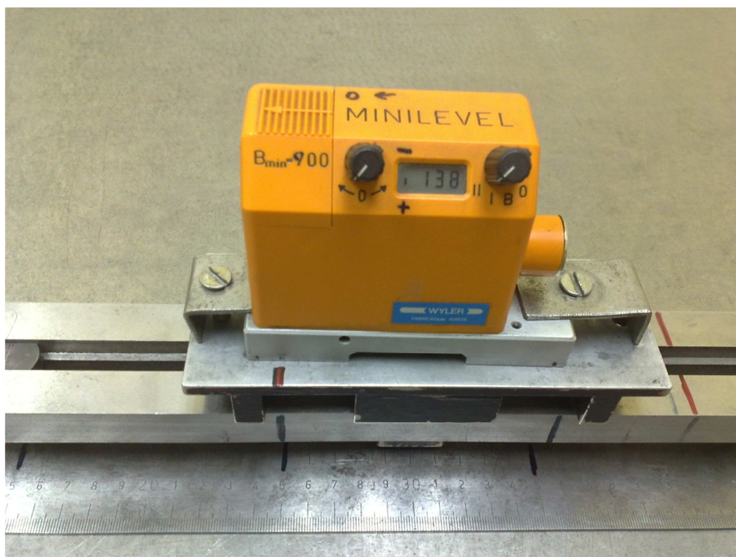
Obrázek 12 Měření relativní výškové polohy na zvolené rozteči 100 mm
