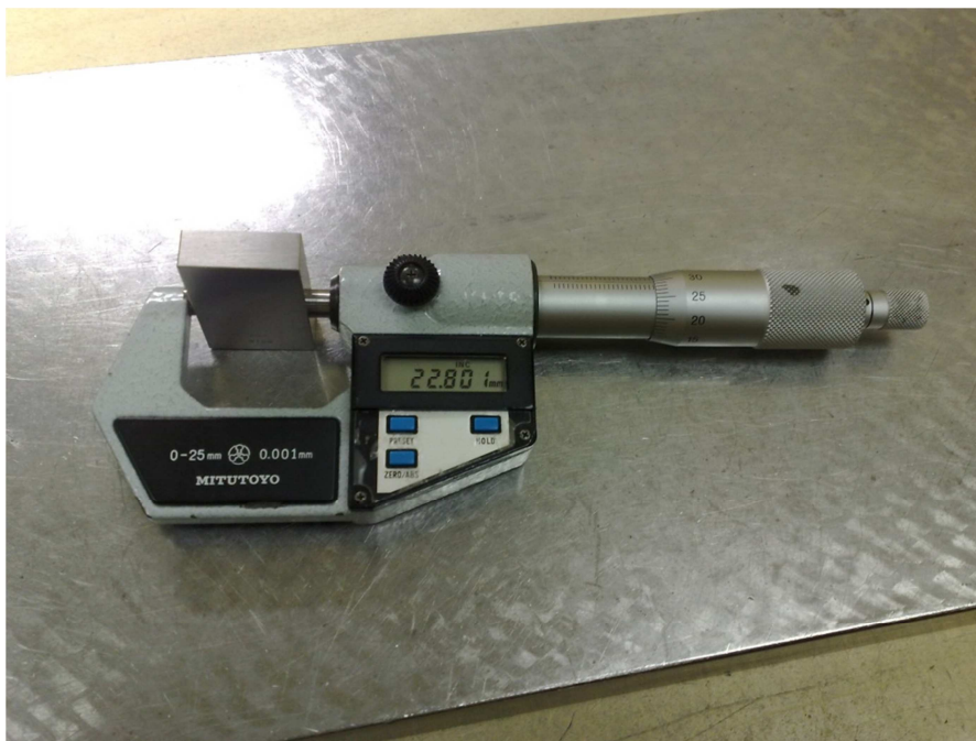
Obrázek 14 Kalibrace digitálního třmenového mikrometru
