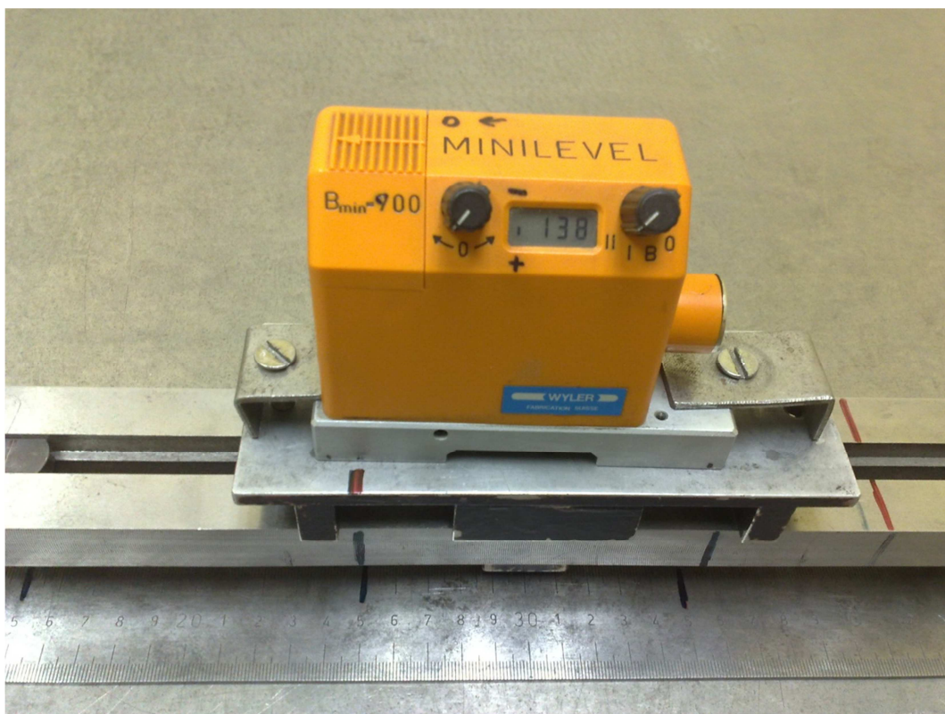
Obrázek 26 Měření relativní výškové polohy na zvolené rozteči 100 mm
