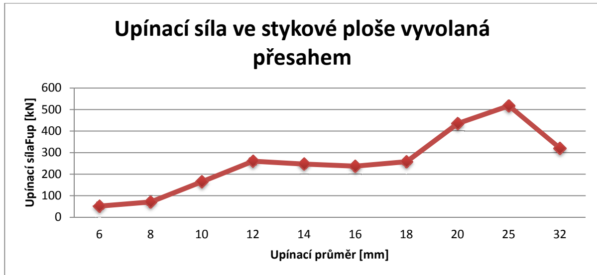
Obr.č.3.1.1-3 – Upínací síla ve stykové ploše vyvolaná přesahem
