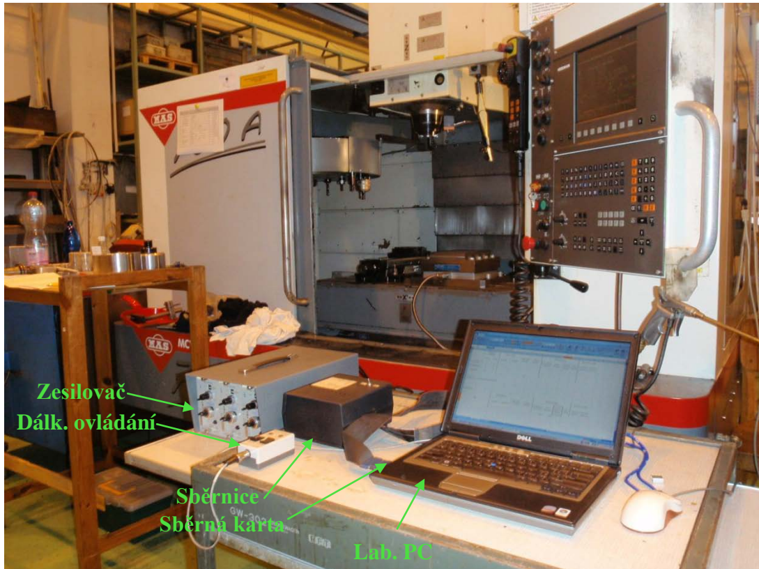
Obr.č.P9-1 – Laboratorní vybavení (zařízení pro měření řezných sil)
