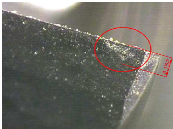
Obr.č.4.4.-2 – Vylomení břitu na čele nástroje u sestavy G52
