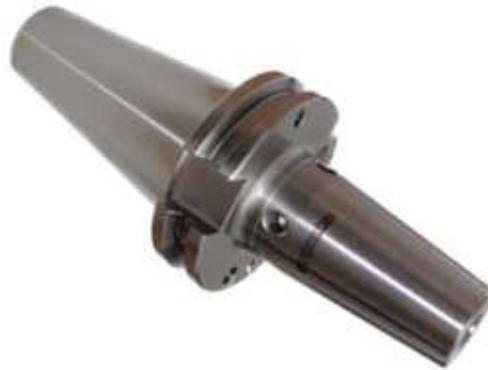
Obr. č. 3.2.2.3-1 – Tepelné upínací pouzdro ISO SK 40 Shrink Fit DIN 69871 (GÜHRING)
