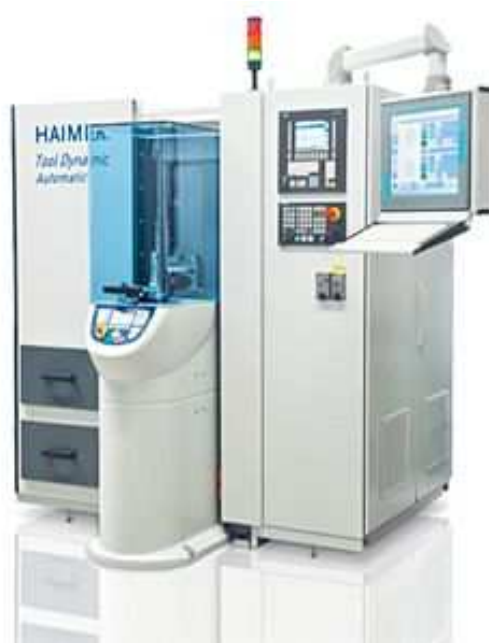
Obr.č.2.2.1.2-1 – Univerzální automatický CNC vyvažovací přístroj HAIMER TD 2010 Automatic s automatickou korekcí nevyvážení [22]
