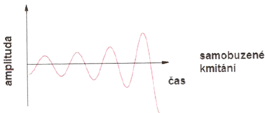
Obr.č.2.2.5.1-1 – Charakteristika samobuzeného kmitání [32]
