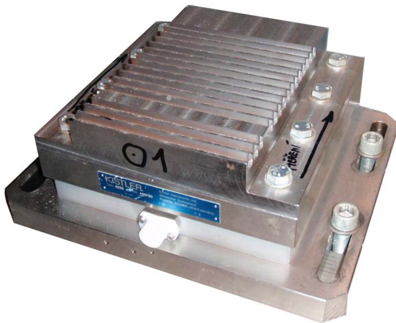
Obr.č.P5-1 – Dynamometr KISTLER 9225 Asp (s upnutým zkušním obrobkem)
