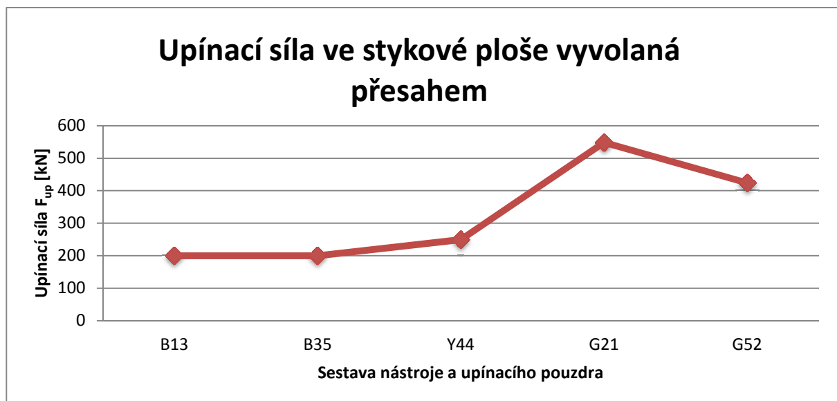
Obr.č.4.1-2 – Upínací síla ve stykové ploše vyvolaná přesahem (Sestavy nástrojů a pouzder)
