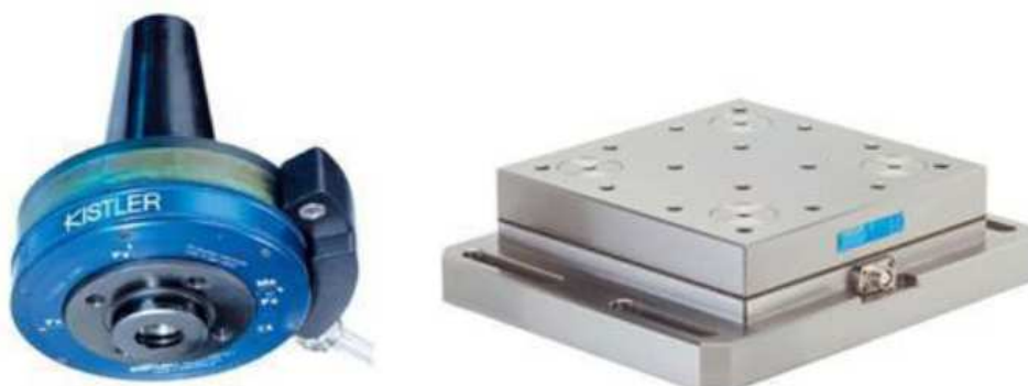
Obr.č.2.3.3.2.1-3 – Moderní piezoelektrické dynamometry KISTLER – rotační (vlevo), statický (vpravo) [3]
