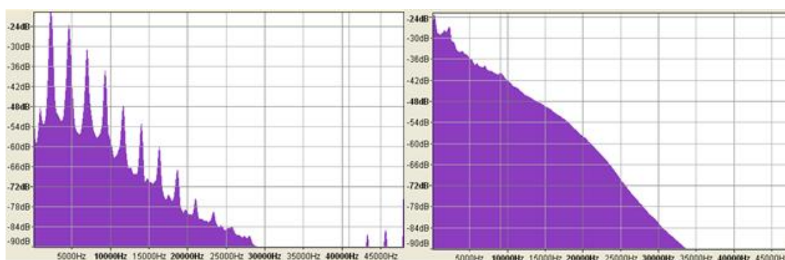
Obr. 28 Frekvenční analýza nestabilního obrábění (vlevo) a stabilního (vpravo) [14]
