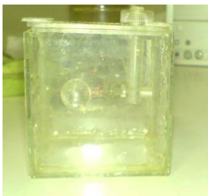
Obr. 11: Pohled na měřicí přípravek, uvnitř vložena skleněná kulička o průměru 10 mm
