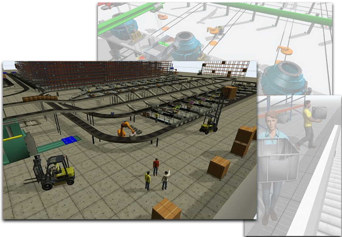
Obr. 4: FlexSim simulace layoutu
