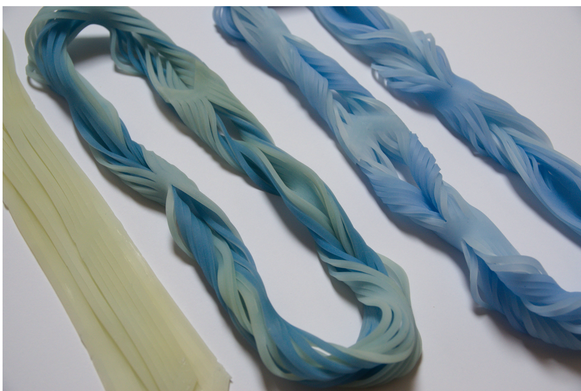
Obrázek 6 Ukázka barevné změny náhrdelníku exponovaného slunečnímu záření v porovnání s novým Zdroj: Vlastní tvorba
