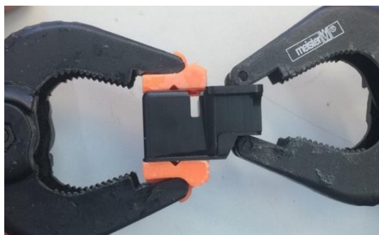
Obr. 65: Přitlačení víčka k housingu pomocí ESD kleští
