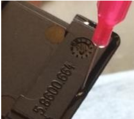
Obr. 30: Aplikace lepidla na víčko
