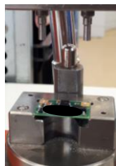
Obr. 22 - Zalisování distančních sloupků do vysílače 1
