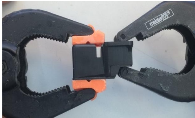
Obr. 29: Přitlačení víčka k housingu pomocí ESD kleští
