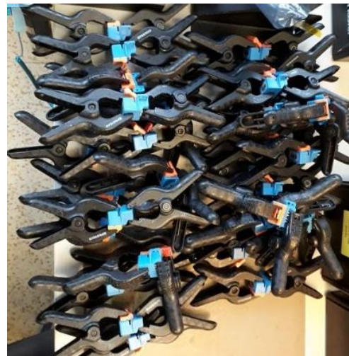
Obr. 31: Nevhodná manipulace s optickými senzory
