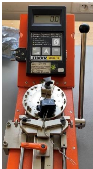
Obr. 33: Interní tahová zkouška
