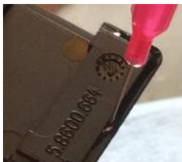
Obr. 64: Aplikace lepidla na víčko
