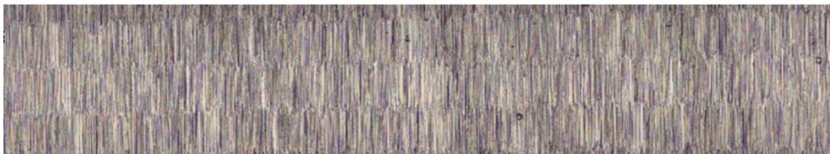
Obrázek 18: Detail broušeného povrchu Inconelu 718 s příčnou vlnitostí [10]
