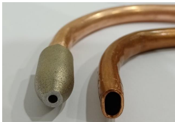
Obrázek 37: Vytištěná Webster/Rouse tryska spolu s klasickou měděnou trubkou
