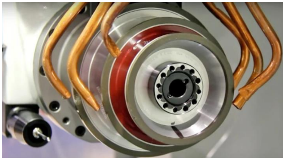
Obrázek 20: Ukázka neefektivního použití ručně zdeformovaných trubek pro přívod procesní kapaliny
