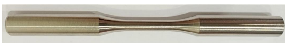
Obrázek 33: Experimentální vzorek v podobě tyčky z tištěného Inconelu 718
