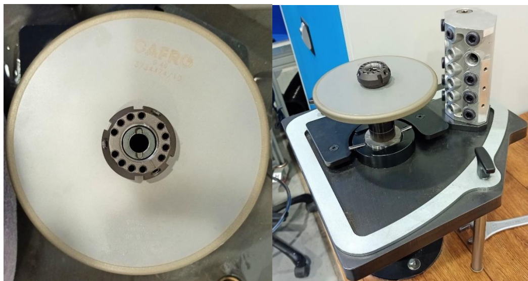
Obrázek 32: Rádusový CBN brusný kotouč 1LL1 (vlevo) + přípravek brusné sestavy (vpravo)
