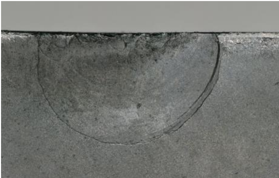
Obrázek 36: Vyštípnutí VBD u vzorku č. 16
