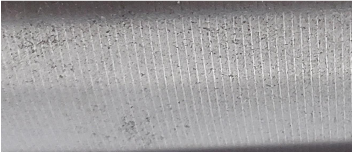
Obrázek 33: Vytrhané částice z povrchu vzorku č. 28
