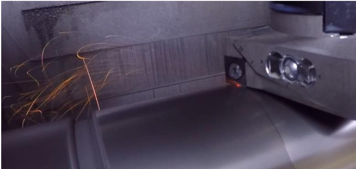
Obrázek 37: Dokončovací soustružení vzorku č. 16
