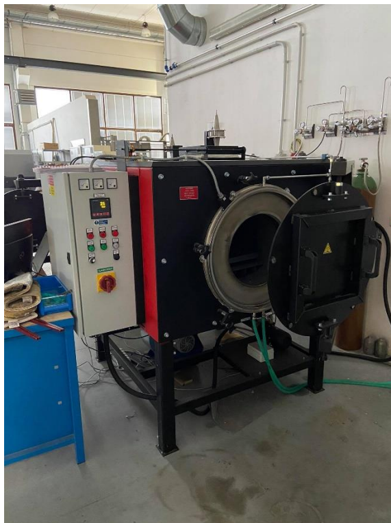
Obr. 25 Plynotěsná komorová pec PKR 35/11 použitá na tepelné zpracování experimentálních vzorků
