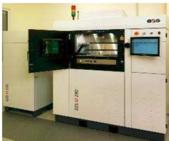
Obr. 23 3D tiskárna použitá na tisk experimentálních vzorků, EOS M290 v Laboratoři experimentálního obrábění RTI
