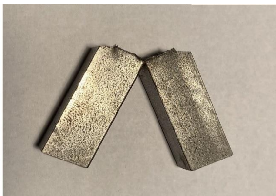
Obr. 29: Vzorek materiálu ČSN 11 373.0 po rázové zkoušce - vrub V
