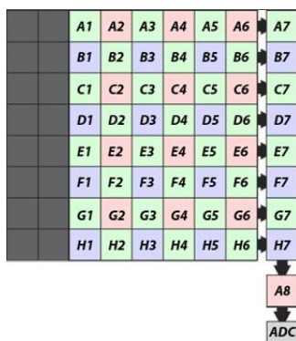
Obr. 16: Vychítání elektrického náboje u CCD senzorů [28]
