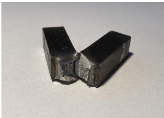
Obr. 30: Vzorek materiálu ČSN 11 373.0 ve vodíkově zkřehlém stavu po rázové zkoušce - vrub U
