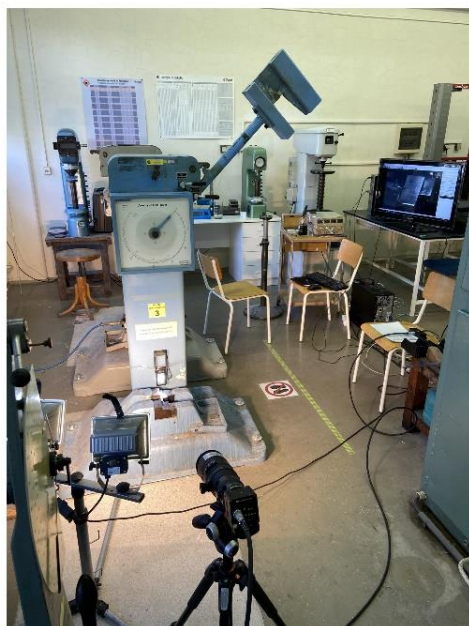
Obr. 26: Uspořádání laboratoře během rázové zkoušky metodou Charpy
