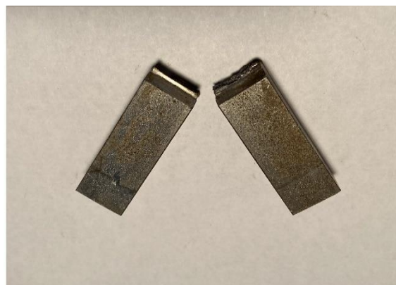
Obr. 31: Vzorek materiálu ČSN 11 373.0 ve vodíkově zkřehlém stavu po rázové zkoušce - vrub V
