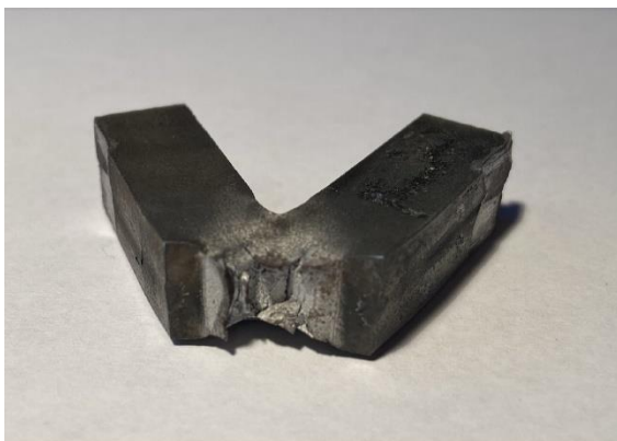
Obr. 35: Vzorek materiálu ČSN 11 373.1 ve vodíkově zkřehlém stavu po rázové zkoušce - vrub V
