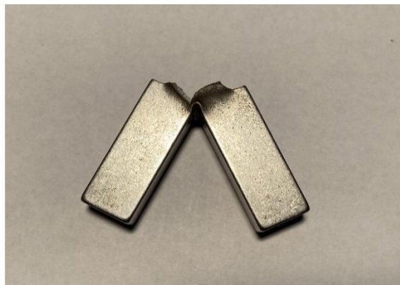
Obr. 28: Vzorek materiálu ČSN 11 373.0 po rázové zkoušce - vrub U
