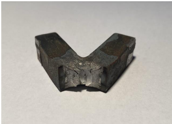
Obr. 34: Vzorek materiálu ČSN 11 373.1 ve vodíkově zkřehlém stavu po rázové zkoušce - vrub U
