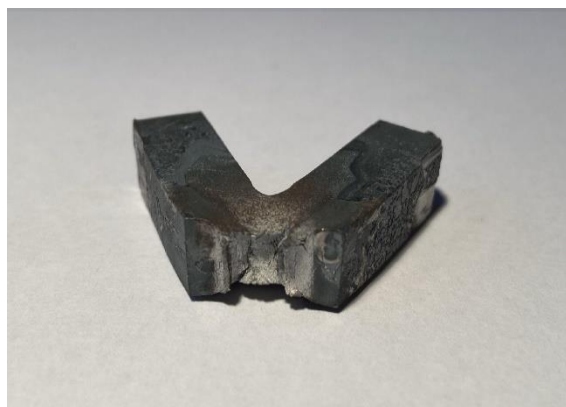
Obr. 33: Vzorek materiálu ČSN 11 373.1 po rázové zkoušce - vrub V
