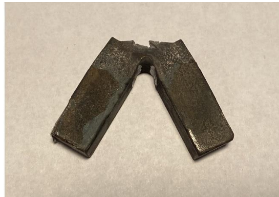
Obr. 34: Vzorek materiálu ČSN 11 373.1 ve vodíkově zkřehlém stavu po rázové zkoušce - vrub U
