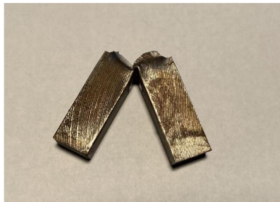
Obr. 30: Vzorek materiálu ČSN 11 373.0 ve vodíkově zkřehlém stavu po rázové zkoušce - vrub U
