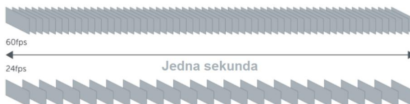
Obr. 19: Porovnání snímkové frekvence 60 fps a 24 fps [37]
