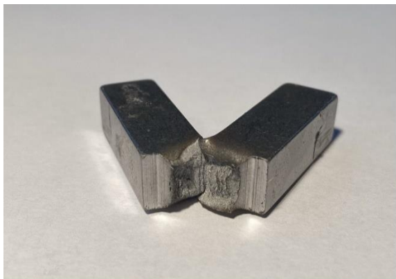
Obr. 28: Vzorek materiálu ČSN 11 373.0 po rázové zkoušce - vrub U
