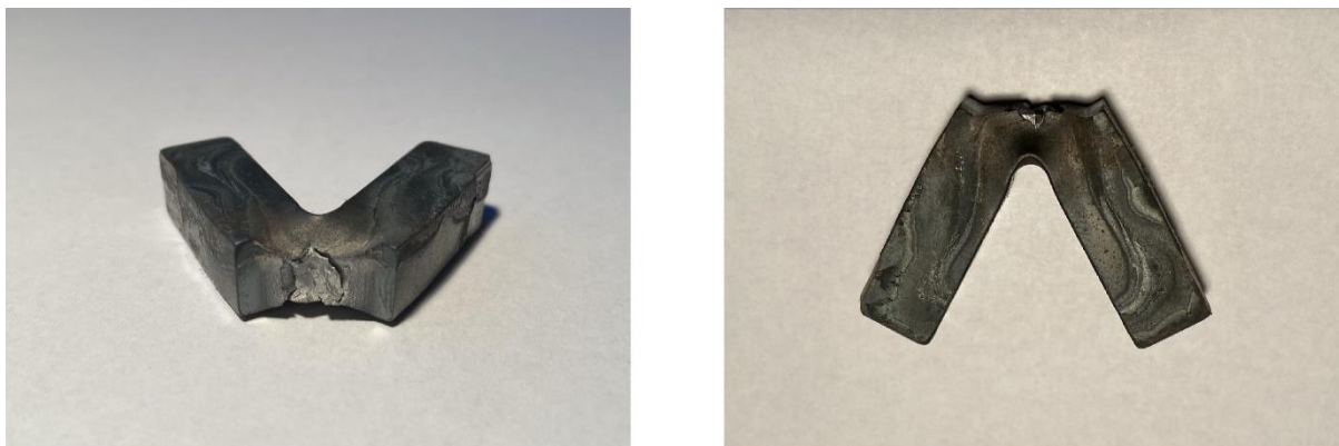
Obr. 32: Vzorek materiálu ČSN 11 373.1 po rázové zkoušce - vrub U
