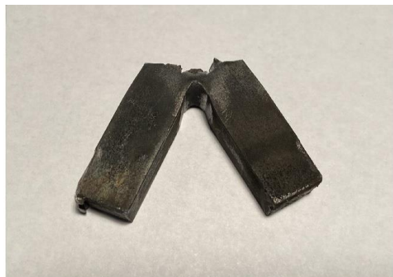
Obr. 35: Vzorek materiálu ČSN 11 373.1 ve vodíkově zkřehlém stavu po rázové zkoušce - vrub V
