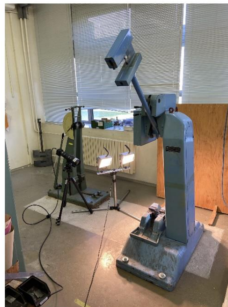
Obr. 26: Uspořádání laboratoře během rázové zkoušky metodou Charpy
