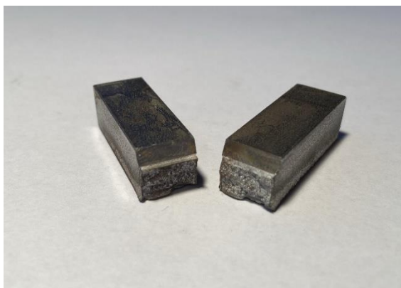
Obr. 31: Vzorek materiálu ČSN 11 373.0 ve vodíkově zkřehlém stavu po rázové zkoušce - vrub V
