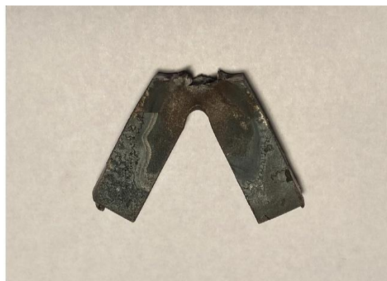
Obr. 33: Vzorek materiálu ČSN 11 373.1 po rázové zkoušce - vrub V
