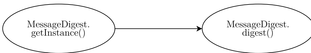
Obrázek 3.6: Schéma použití třídy MessageDigest
