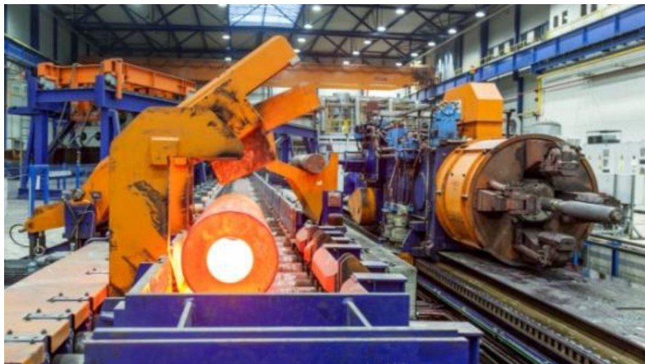
Obrázek 4-10: Vstupní polotovary pro tváření tenkostěnné trubky, zařízení SMS SMX 800, Vítkovice Česká republika [18]
