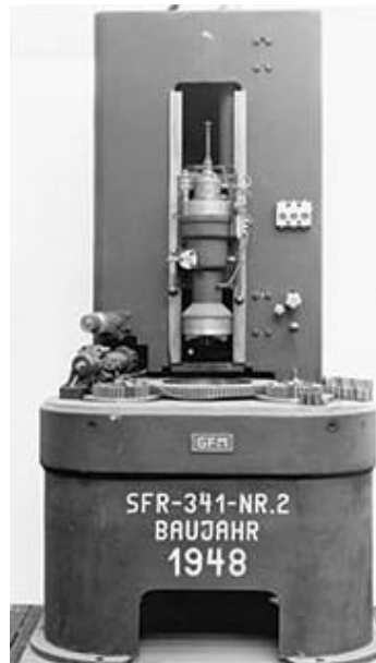
Obrázek 4-5: Druhý postavený radiální kovací stroj vertikální koncepce [8]
