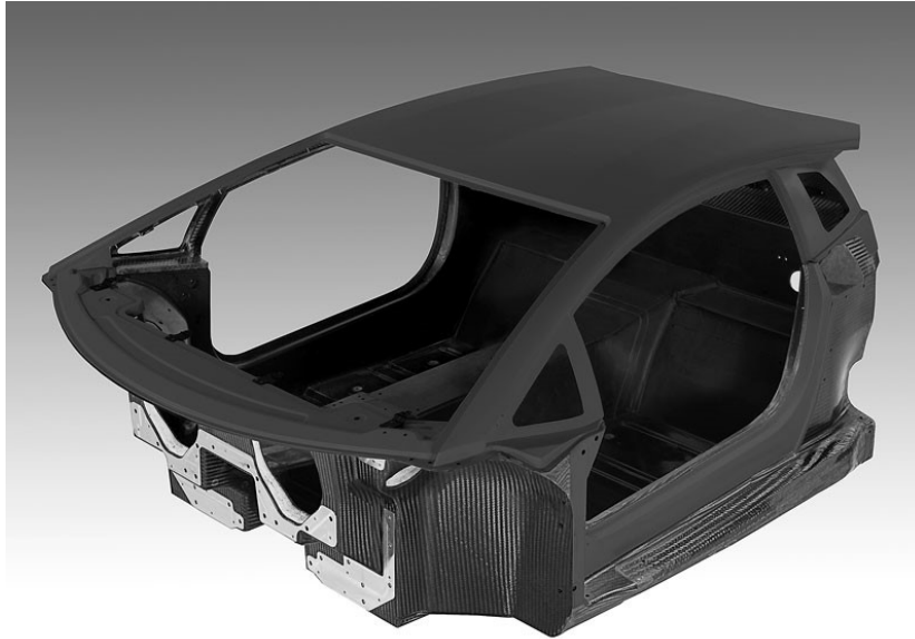
Obrázek 7 - karbonový monokok Lamborghini Aventador [18]
