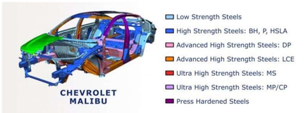
Obrázek 6 - oceli použité na výrobu karoserie [15]
