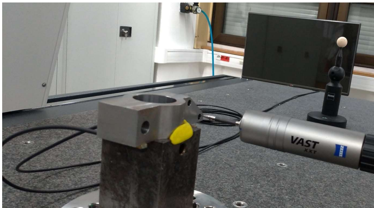
Obrázek 17 - měření dotekem o průměru 1.5 mm
