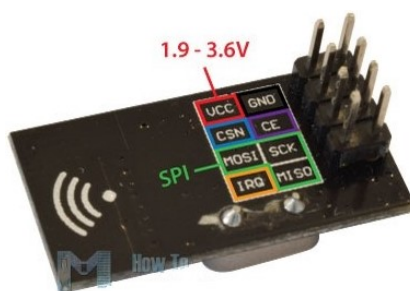
Obrázek 11: Popis vývodů bezdrátového modulu nRF24L01 [15]
