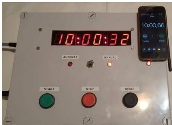
Obrázek 38: Testování přesnosti čítání času
