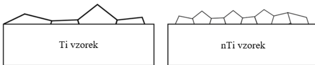
Obr. 27: Ilustrační znázornění rozdílu povrchů vzorků Ti a nTi; při stejném objemu vzorků je povrch pro nTi větší, dochází tedy k větší kontaminaci povrchu. Foto autor.
