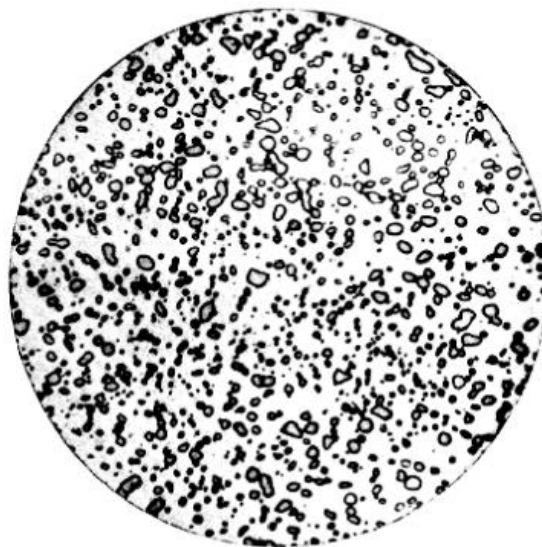
Obrázek 3: Mikrostruktura nástrojové oceli po žíhání na měkko a sferoidizaci karbidů [1].
