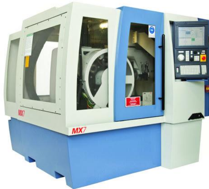
Obrázek 40: Nástrojářská bruska pro přípravu utvařečů třísek na vyměnitelných břitových destičkách [43].
