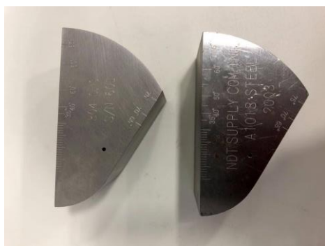
Obr. 50 – Měrky K2 použité pro kalibraci TCG: 304 nerezová ocel (vlevo) a A1018 ocel (vpravo)
