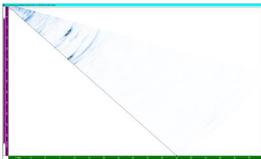
Obr. 61 – Kalibrační měrka, S-sken 30° - 80°, FMC/TFM: 2 celá echa vývrvtů, 1 částečné
