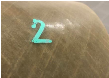
Obr. 81 – Nerovnosti povrchu na tělese LAM – 1.1
