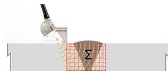
Obr. 29 – Oblast sběru dat pomocí FMC/TFM [63]
