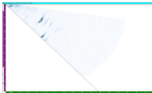
Obr. 62 – Kalibrační měrka, S-sken 40° - 80°, FMC/TFM: 1 celé echo vývrvtu, 1 částečné
