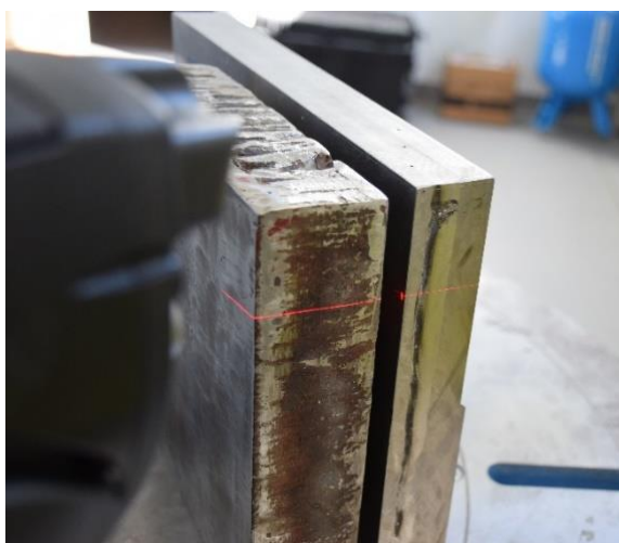
Obr. 90 – Správné skenování monitorované pomocí kontrolního bodu ležícího na linii bodů
