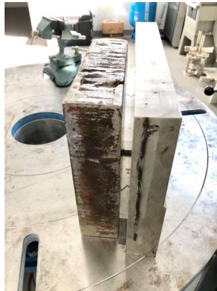
Obr. 85 – Simulace mezery pomocí dvou nerezových těles a koncových měrek s rozměrem 10 mm
