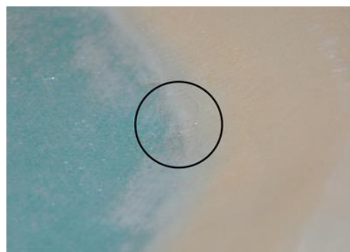
Obr. 4 – Označená menší delaminace [9]
