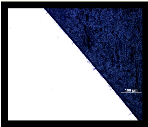
Obr.57 a Obr. 58: Trhlíny v příčném výbrusu čela vzorku B4 po zpevnění LSP – leptáno činidlem Adler
