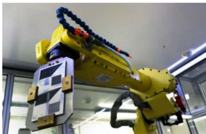
Obr. 12: Šestiosé robotické rameno Fanuc M-20iA / 20M využívané při aplikaci technologie LSP [19]
