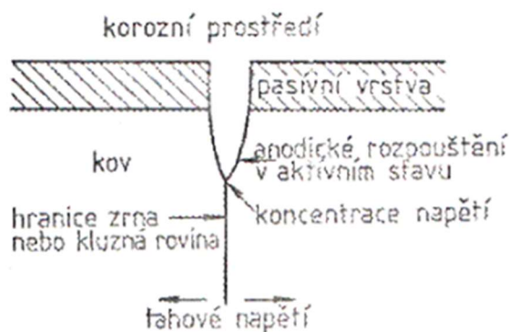
Obr. č. 10 – Mechanismus korozního praskání [15]
