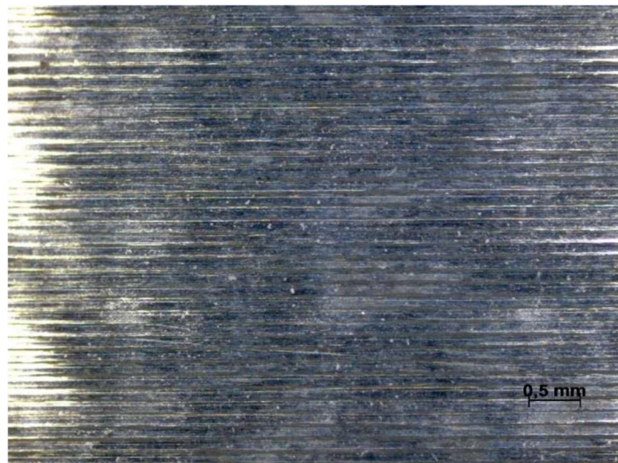
Obr. 32: Vzorek B4 po 15 hodinách v lázni MgCl_2
