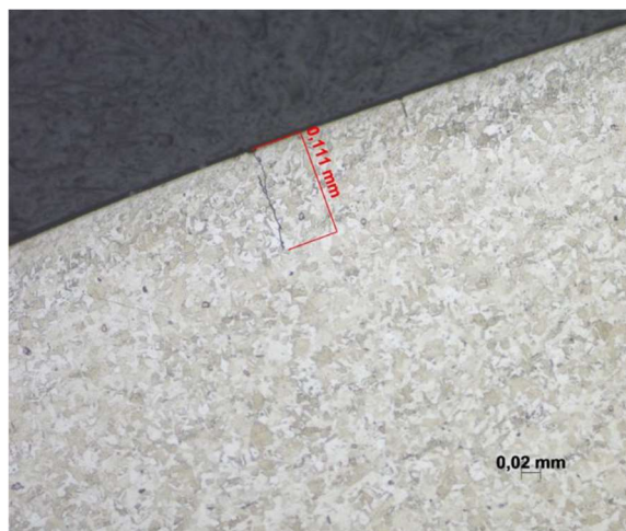
Obr. 59: Detail trhlíny v příčném výbrusu čela, na krajích vzorku B4 po zpevnění LSP – leptáno činidlem Adler
