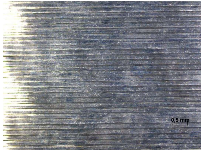
Obr. 31: Vzorek B4 po 12 hodinách v lázni MgCl_2
