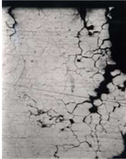
Obr. 11: Interkrystalické šíření trhlin [17]
