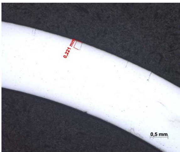
Obr. 49 a Obr. 50: Trhliny v příčném výbrusu středem vzorku A4 bez zpevnění LSP a detail trhliny – leptáno činidlem Adler
