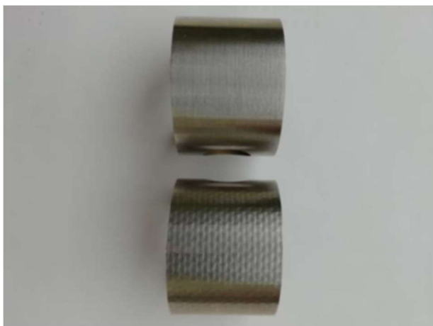
Obr. 14: Zhotovený vzorek bez aplikace LSP na horní části a po aplikaci LSP na dolní části obrázku
