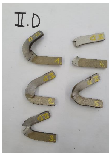
Obrázek 66: vzorky 2.D po měření K_8
