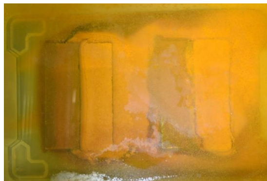
Obrázek 16: Vzorek D (kotlová voda + 0,05 % NaCl) při ukončení korozního testu
