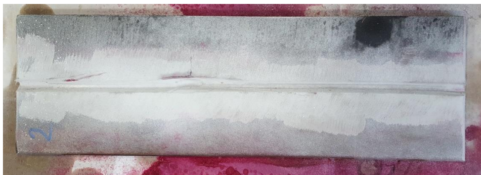
Obrázek 12: Kapilární zkouška při opravě svaru č. 2, svarové plochy jsou bez indikací, indikace na okrajích svarových ploch vznikly v důsledku přítomnosti rýh vzniklých při vybrušování
