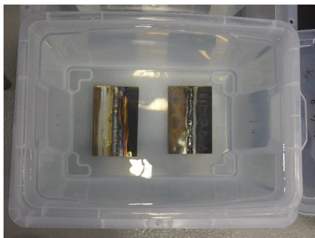
Obrázek 14: Ponořené vzorky v elektrolytu při zahájení korozního testu
