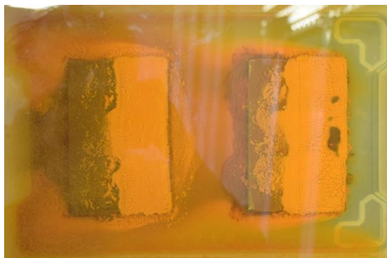
Obrázek 15: Vzorek B (kotlová voda) při ukončení korozního testu
