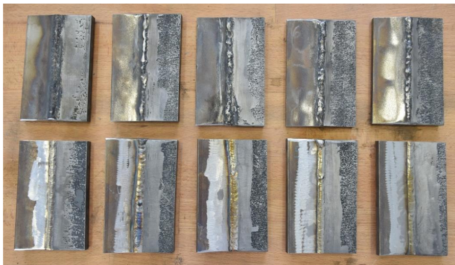
Obrázek 18: Vizuální hodnocení koroze, horní řada vzorky 1, dolní řada vzorky 2, seřazeny B až F zleva, strana austenitické oceli vždy na levé straně
