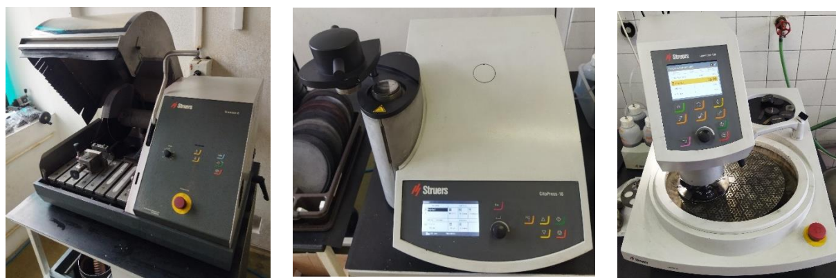
Obrázek 24 - Nalevo metalografická pila, uprostřed elektrohydraulický lis, napravo automatická bruska
