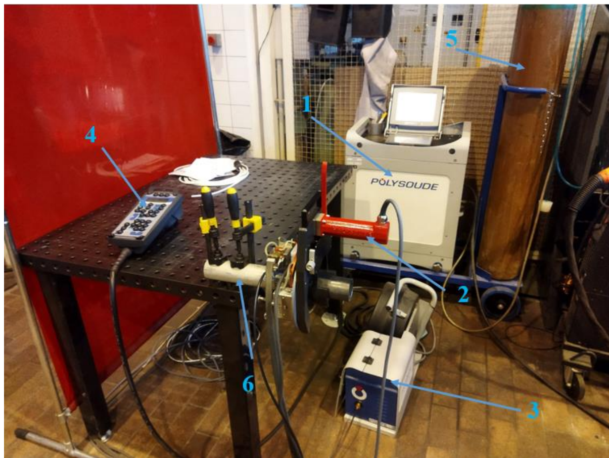
Obrázek 22 - Svařovna a komponenty využití pro svařování; 1 - svařovací zdroj P6, 2 - svařovací hlava MUIV 115, 3 - podavač drátu P3, 4 - dálkové ovládání, 5 - lahev s argonem, 6 – svařenec
