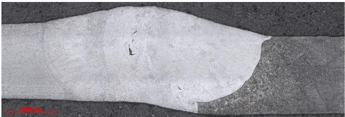
Obrázek 32 - Makro vzorku T7Sv - 7/4, zvětšeno 25x, leptáno roztokem HCl, H 2 O a HNO 3
