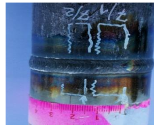
Obrázek 30 - Označení pozice odběru vzorků
