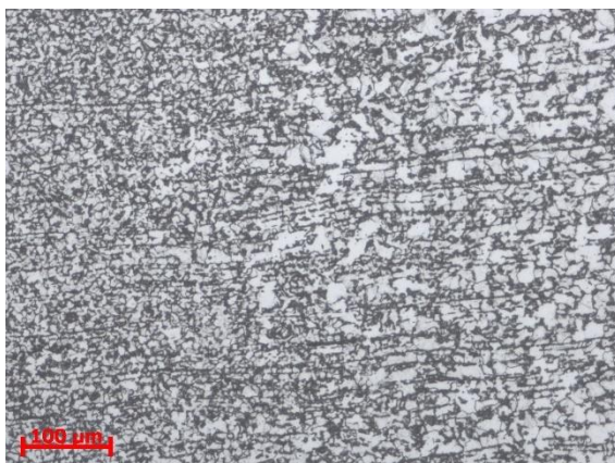
Obrázek 36 - Vzorek T7Sv/4, zvětšeno 100x, leptáno roztokem HCl, H 2 O a HNO 3
