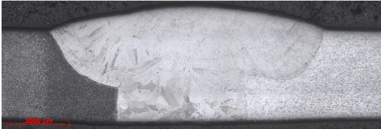
Obrázek 31 - Makro vzorku T7Sv - 7/1, zvětšeno 25x, leptáno roztokem HCl, H 2 O a HNO 3
