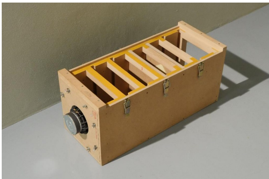
Obrázek 8-1: Foto menšího modelu měřící ozvučnice.
