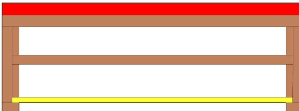
Obrázek 5-1: Průřez měřicího modelu bez vnitřního tlumicího porézního materiálu.
