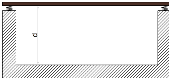
Obrázek 2-2: Náčrt kmitajícího panelu se vzduchovým polštářem.
