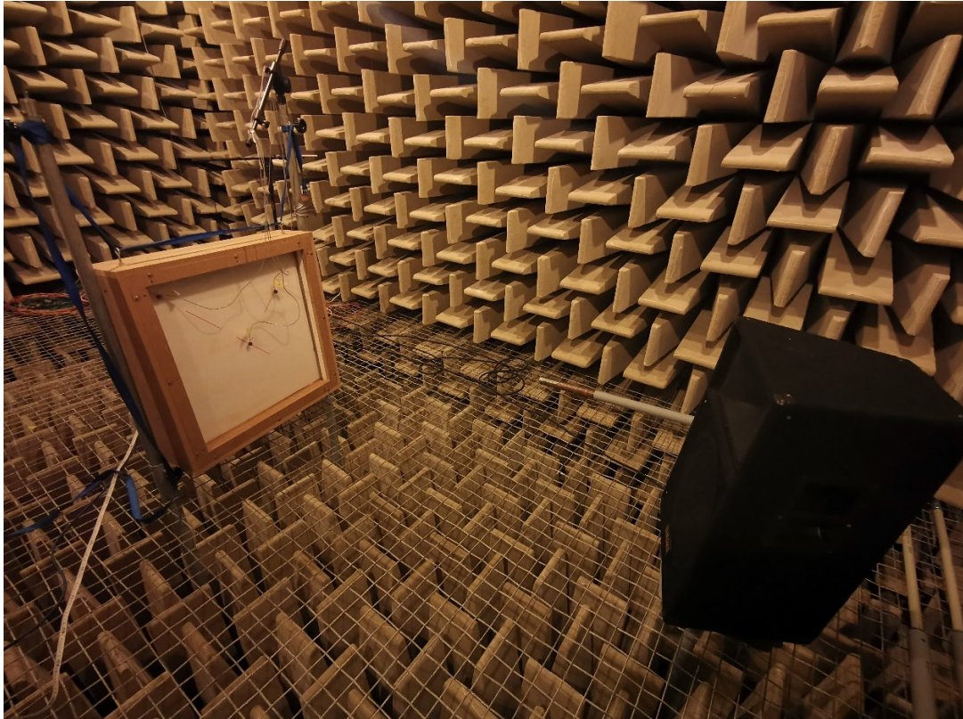
Obrázek 5-6: Rozmístění měřicí techniky v bezodrazové místnosti.
