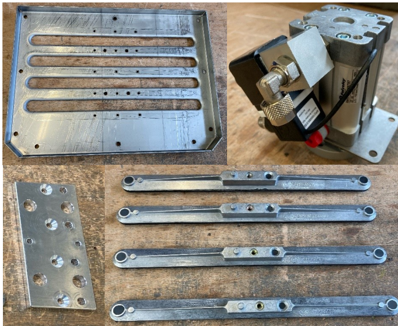
Obr. 36 Plechový rám, ovládací mechanismus, spojovací plech a regulační lamely
