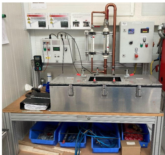
Obr. 37 Zkušební pracoviště tlakových ventilů
