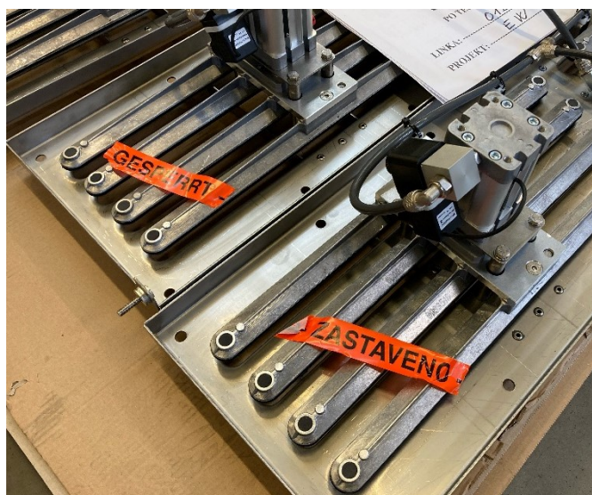
Obr. 39 Neúspěšně otestovaný tlakový ventil
