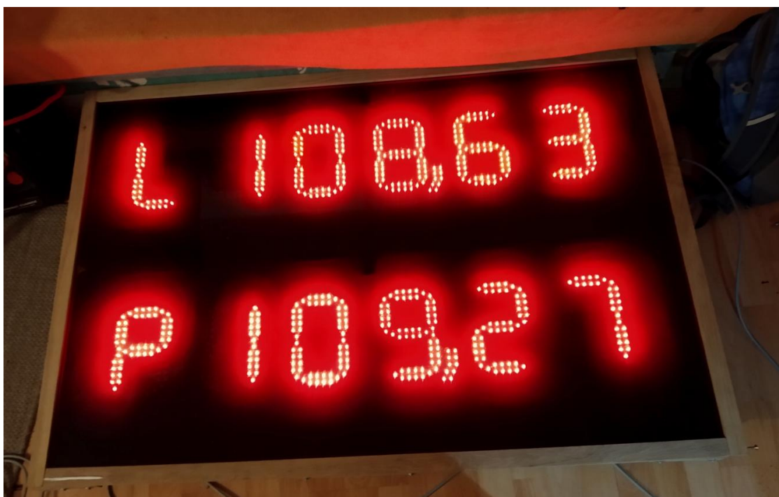
Obr. 24: Konstrukce velkého segmentového displeje
