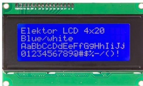
Obr. 9: LCD displej 4x20 znaků s řadičem HD44780 [21]
