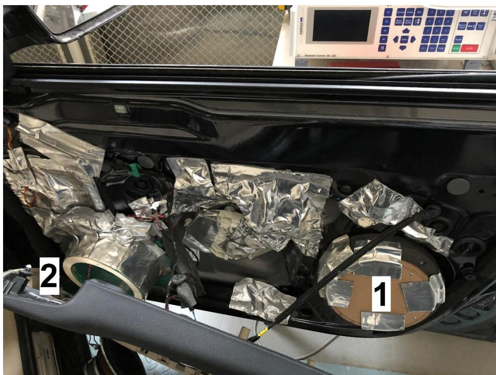
Obr. 4.3: Částečné vytlumení předních dveří
