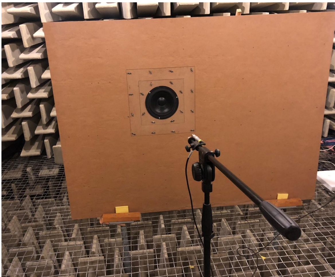
Obr. 5.5: Měření v bezodrazové komoře
