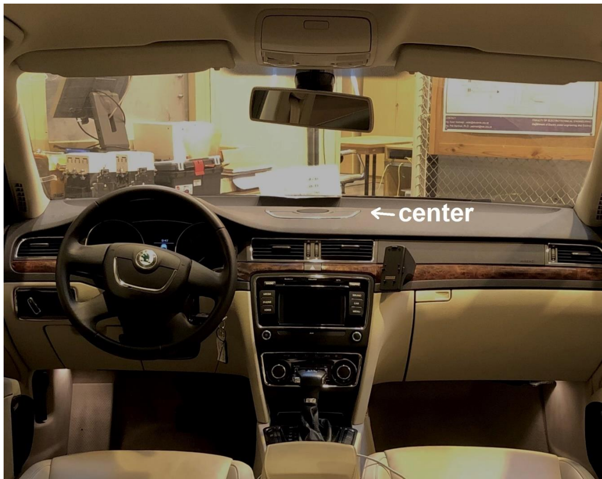
Obr. 4.4: Umístěný center reproduktor na palubní desce
