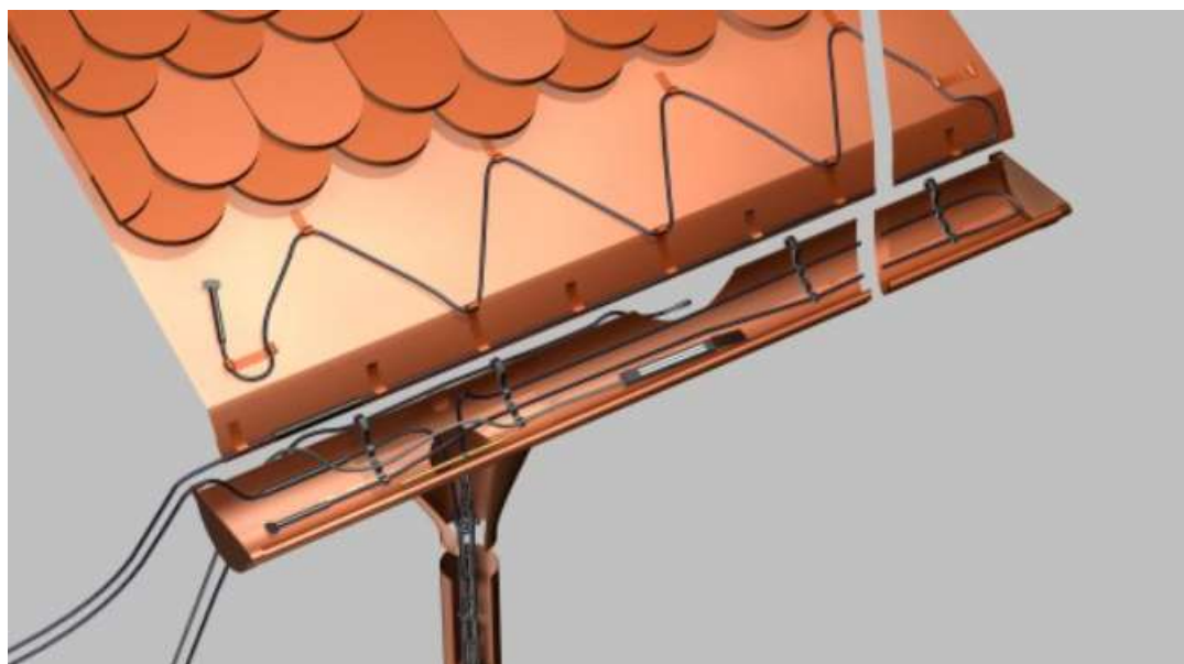
Obrázek 7 - Topné kabelové okruhy
