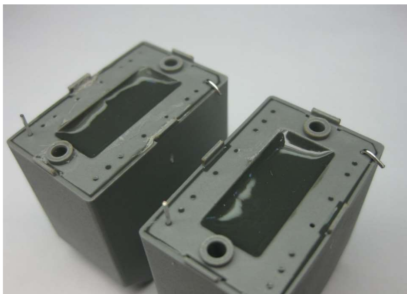
Obr. 33 Ohnuté piny nevhodným zabalením
