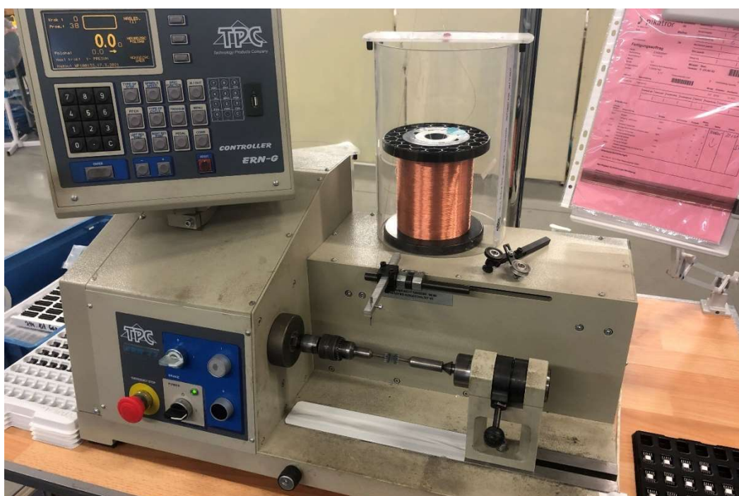
Obr. 3 Lineární navíjecí stroj TPC ERN 22 s příslušenstvím
