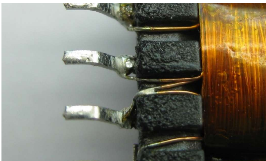
Obr. 30 Porušená minimální izolační vzdálenost mezi vývody v oblasti kostry
