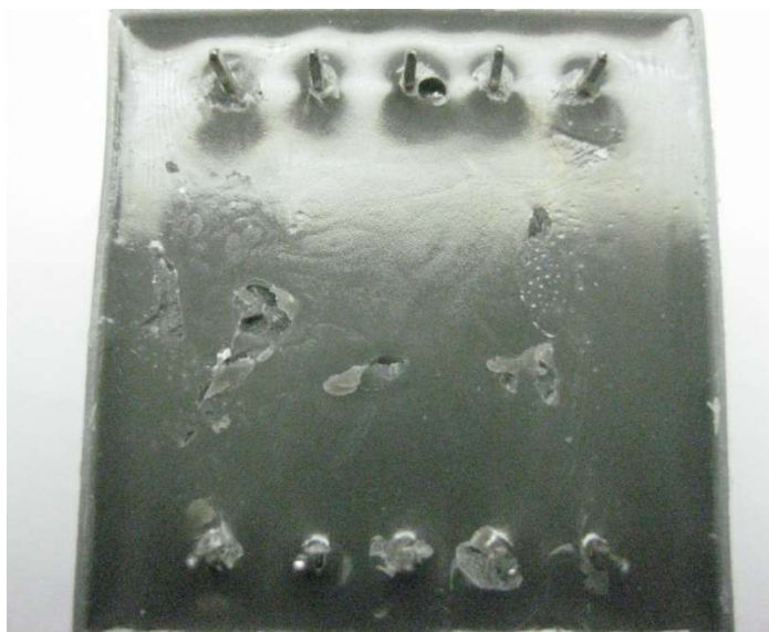
Obr. 17 Zalévací hmota – makroskopické nehomogenity
