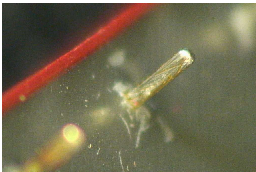
Obr. 20 Zákaznická reklamáce – Poškozená cínová vrstva pinu
