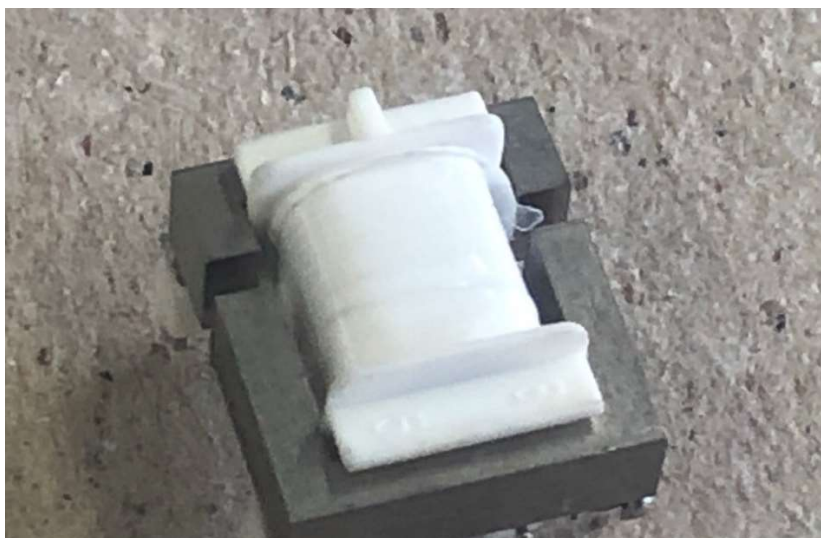
Obr. 22 Závěrečná bandáž mezi feritovými jádry
