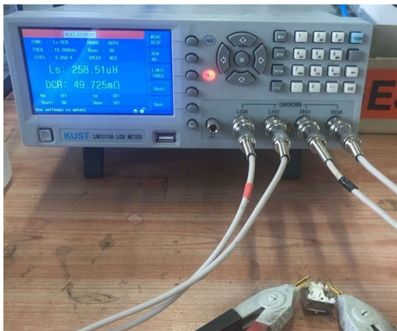
Obr. 23 Izolace mezi feritovými jádry – Elektrické vlastnosti před opravou
