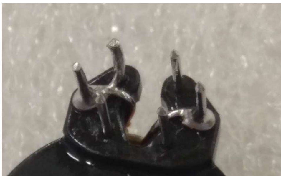
Obr. 10 Cínový můstek mezi osazeným a neosazeným pinem
