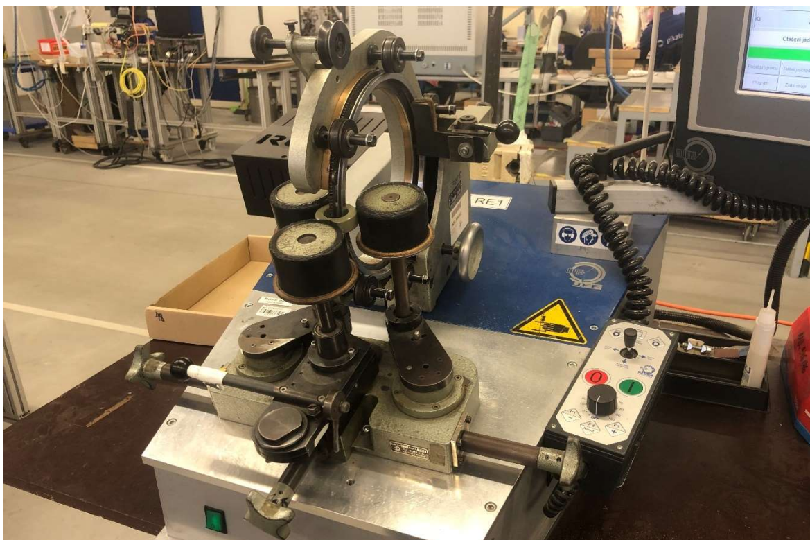
Obr. 5 Navíjecí ústrojí toroidní navíječky RUFF RWE Evolution
