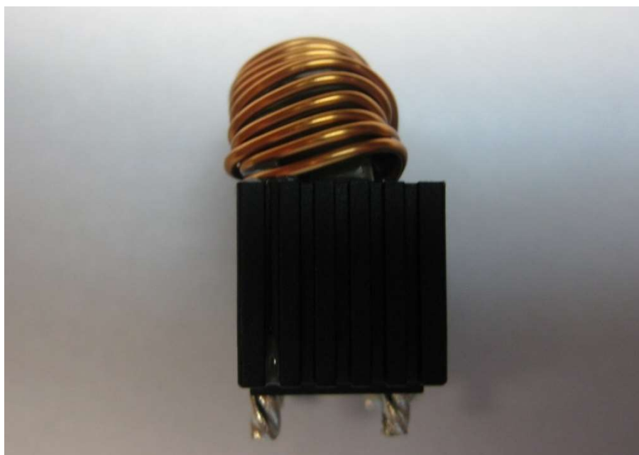
Obr. 12 Do krabičky nedbale osazená toroidní cívka
