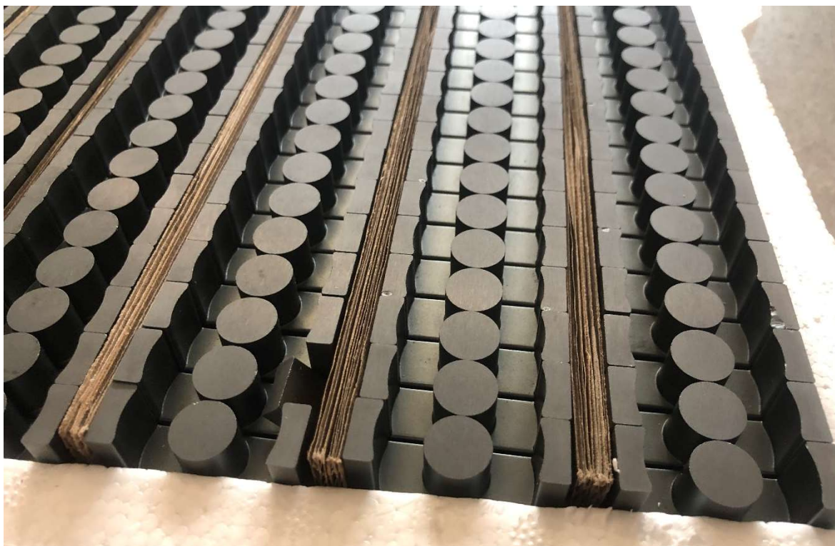
Obr. 1 Feritová jádra ETD34-PL7 Ls 2,2mm poškozena přepravou
