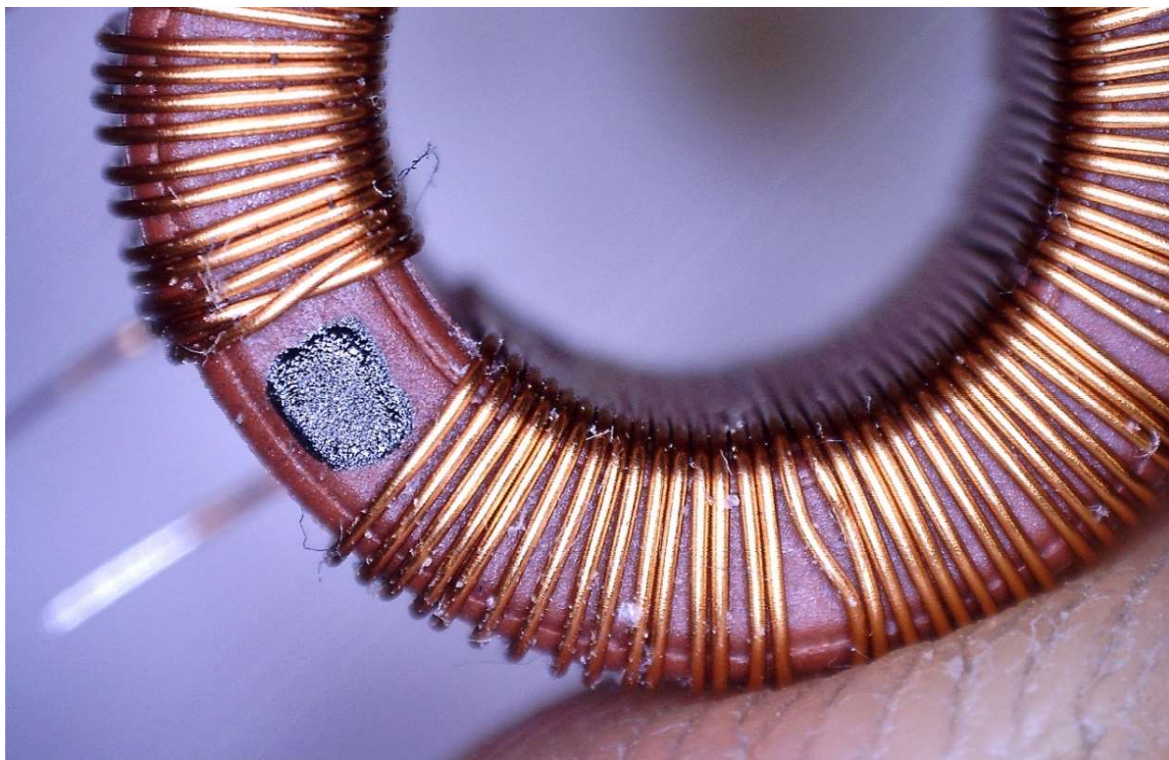
Obr. 7 Zkřížené vodiče vinutí
