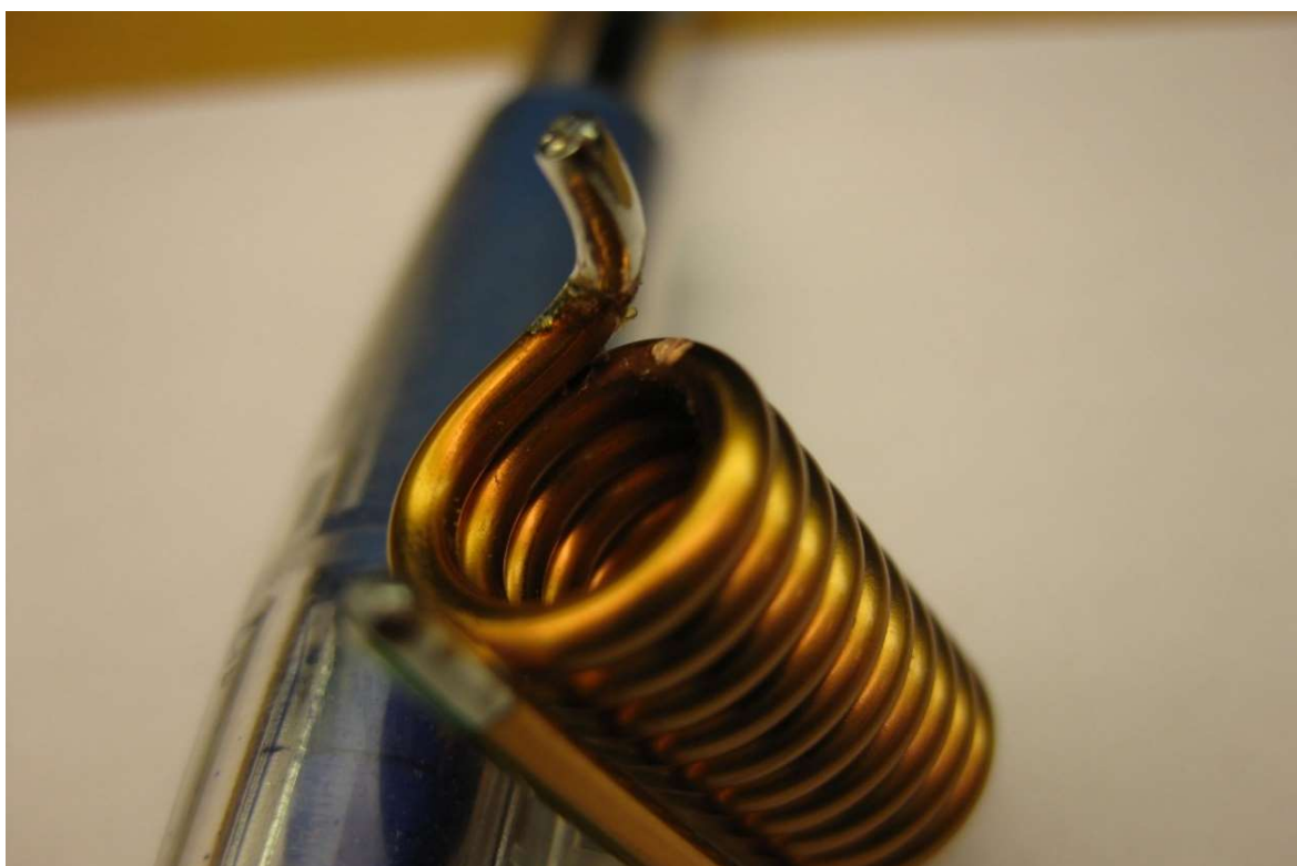
Obr. 14 Poškozený vodič vinutí po mechanickém odizolování přístrojem Abisofix
