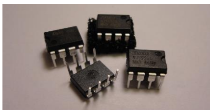
Obr. 2.1 Plastová pouzdra DIP (převzato z [14])
