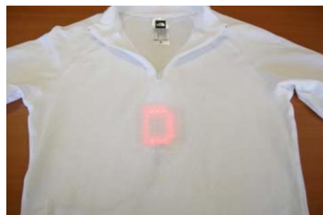
Obr. 3.5 Flexibilní hybridní matice přilepená k textilu (převzato z [38])
