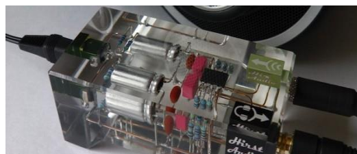
Obr. 2.3 Obvod zalitý v epoxidu (převzato z [6])
