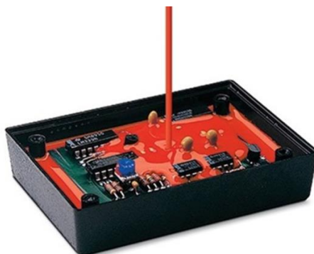
Obr. 2.4 Zalévání napájecího zdroje pro automotive (převzato z [17])
