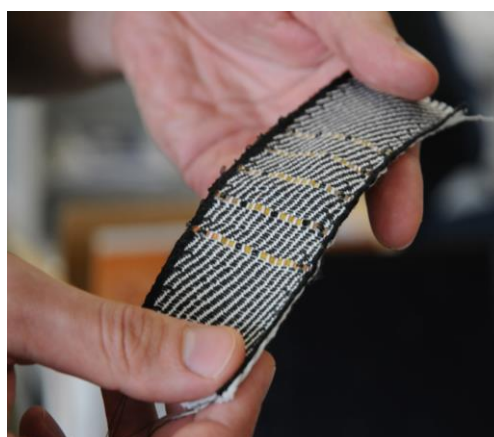
Obr. 3.17 Vrstvy kaptonového pouzdra (převzato z [42]) Obr 3.18 Textilie s vetkanými kaptonovými pásky (převzato z [43])
