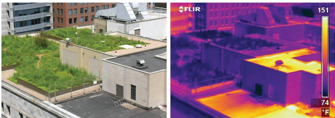
Obrázek 6 - Teplotní rozdíl střech s vegetací a bez vegetace [2]
