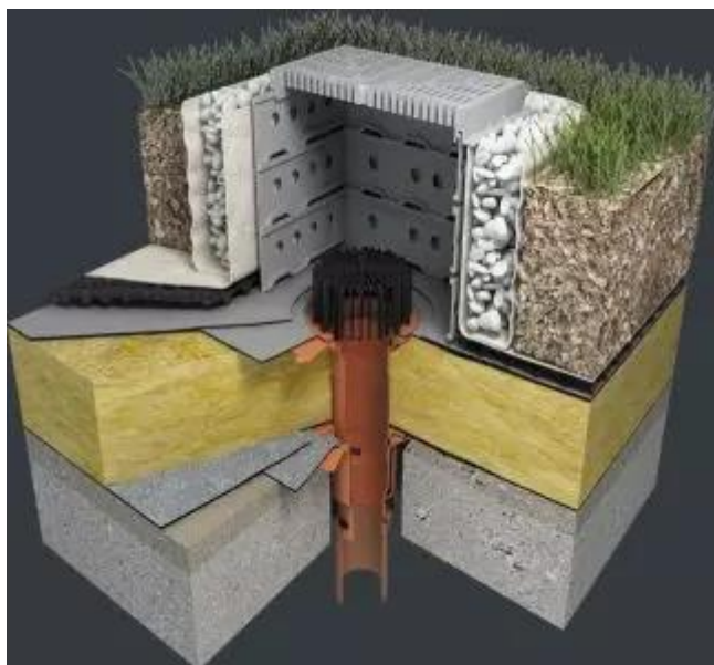
Obrázek 5 - Řešení vpusti u vegetačních střech [6]
