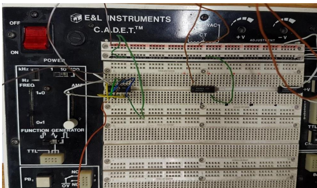
Obrázek 48 Zapojení logické funkce XOR. Zdroj: Vlastní.
