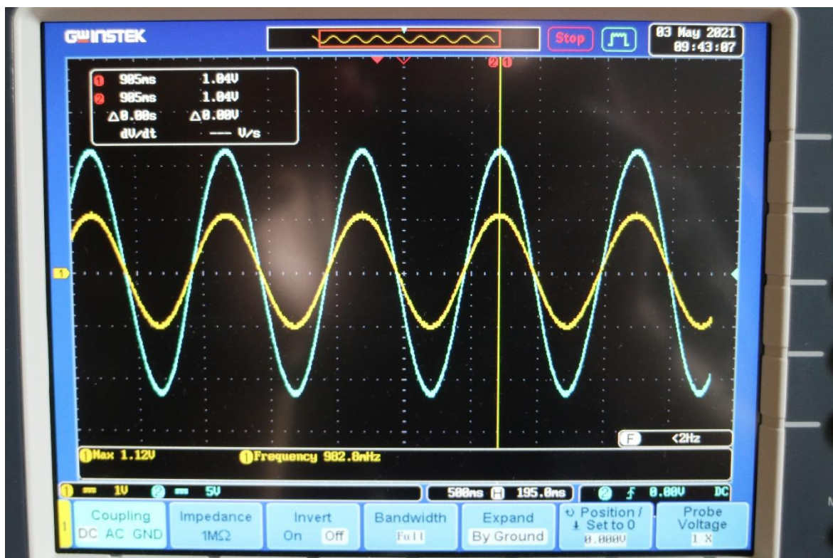
Obrázek 17 Neinv. zapojení OZ – měřený výstupní signál. Zdroj: vlastní.
