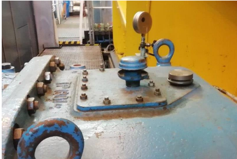
Obrázek 37: Demontovaný odvzdušňovač s nástavcem a namontovaný prototyp
