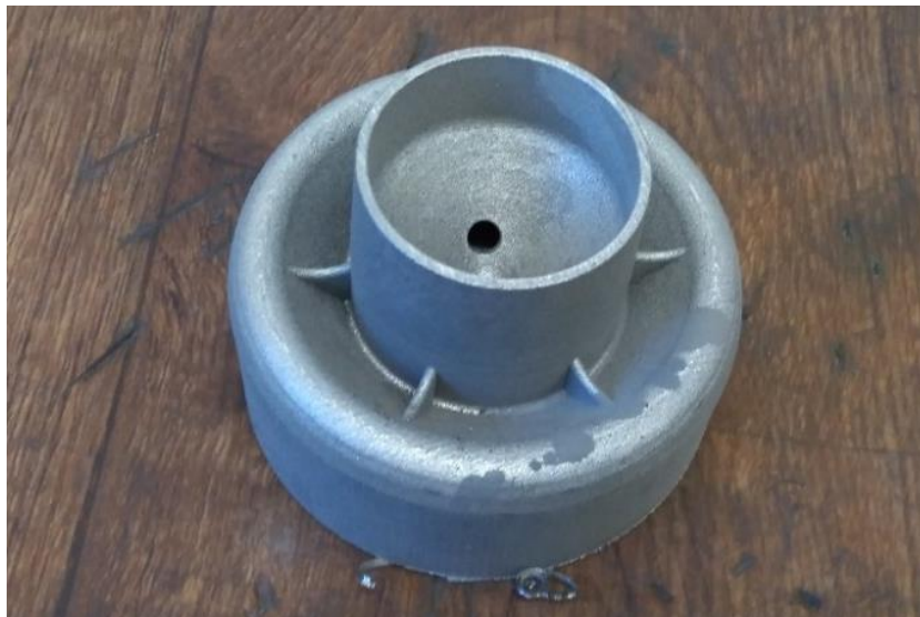
Obrázek 44: Vytištený odvzdušňovač po oddělení od platformy
