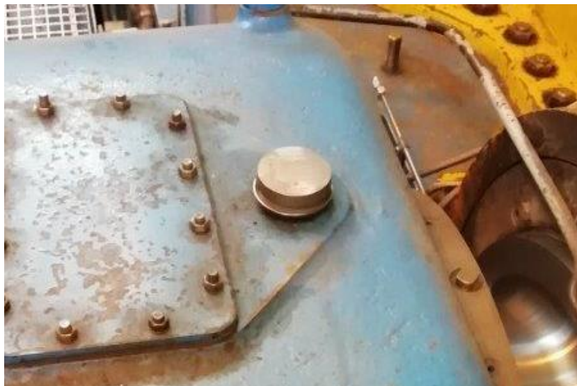
Obrázek 38: Prototyp umístěný na víku ložiskového stojanu
