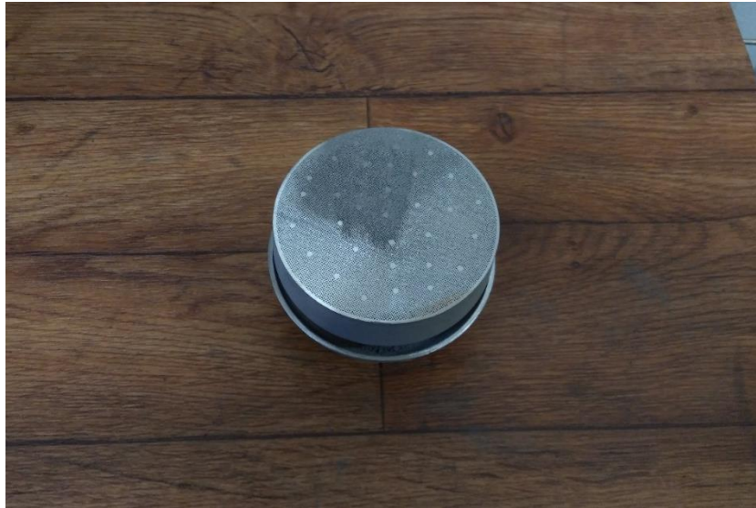
Obrázek 47: Po zámečnickém odstranění podpěry a vyčištění od zbytků prášku
