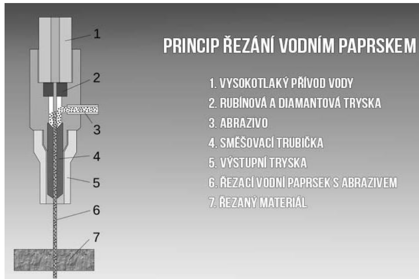
Obrázek 12: Řezání vodním paprskem s abrazivem [19]
