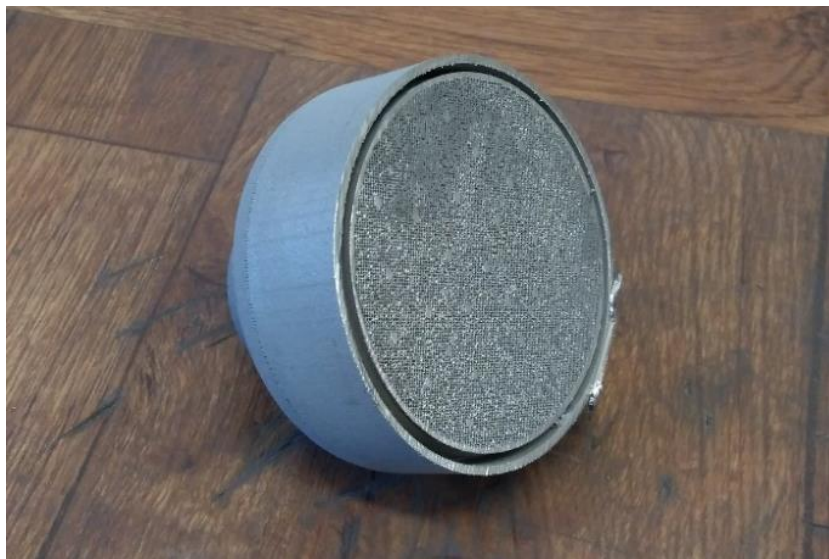
Obrázek 43: Vytištený odvzdušňovač po oddělení od platformy
