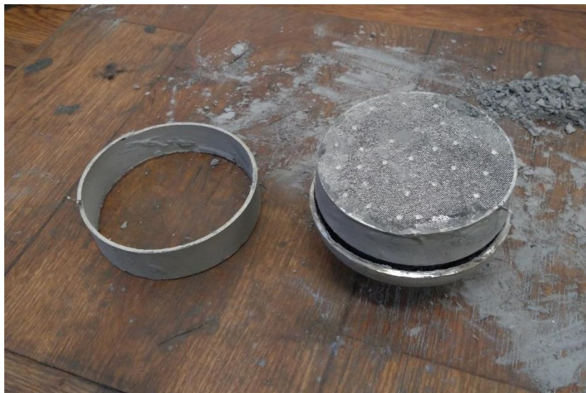
Obrázek 46: Po odříznutí nosné podpěry a odstranění zbytků prášku z dutin
