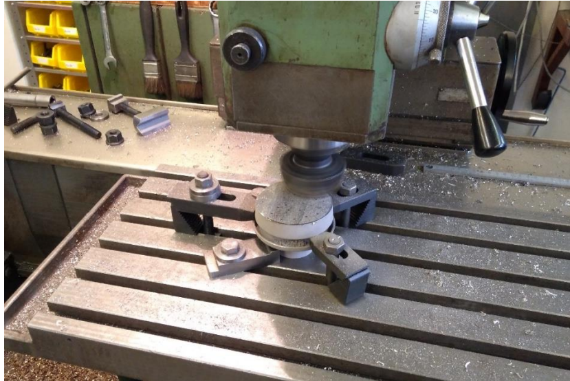
Obrázek 49: Strojní odstranění podpěr
