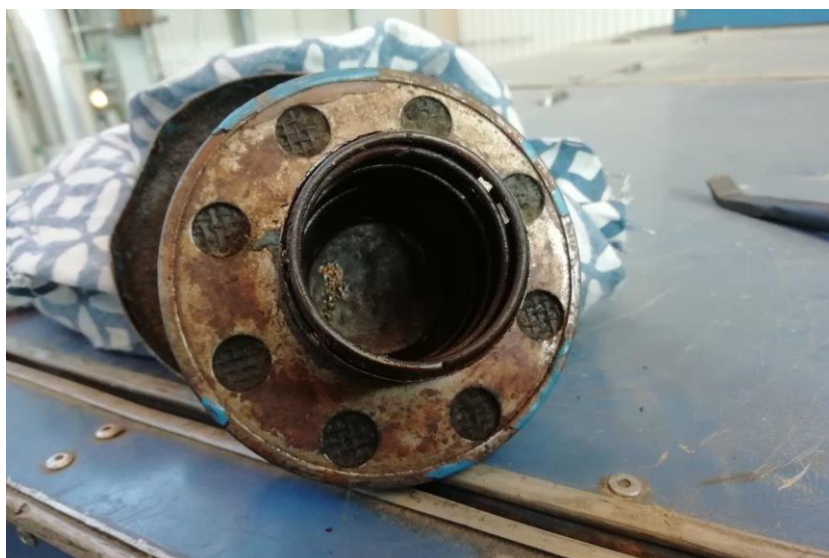
Obrázek 36: Provozní znečištění původního odvzdušňovače
