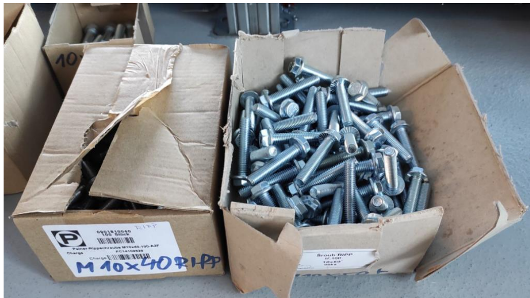
Obrázek 19: Ukázka způsobu uložení kovového instalačního materiálu. [vlastní zpracování]
