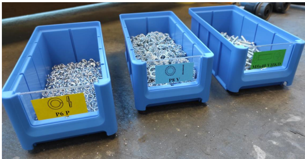
Obrázek 28: Ukázka nového způsobu značení kovového instalačního materiálu. [vlastní zpracování]
