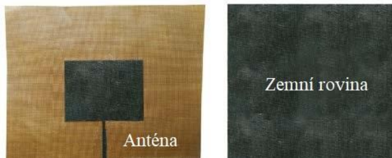
Obr. 1 Ukázka antény s textilní zemní rovinou (převzato z [16])
