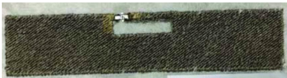
Obr. 12 Vyšitá štěrbinová flíčková (patch) anténa s přilepeným IC (převzato z [25])
