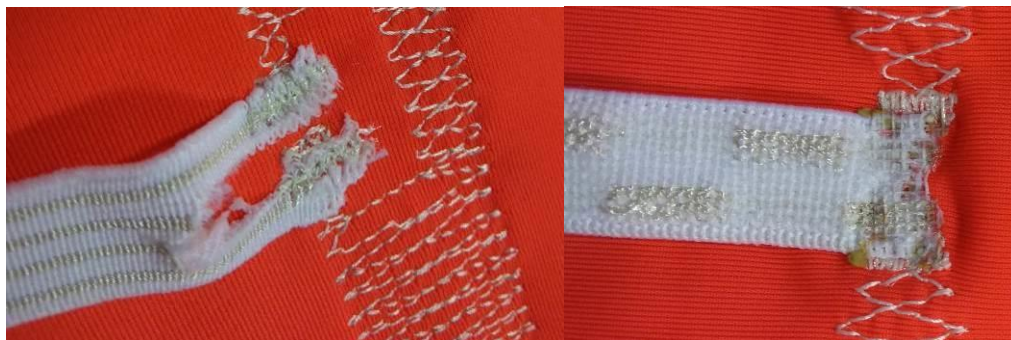
Obr. 52 Detail na připojení vodivé stuhy k textilní anténě – vlevo přišité, vpravo odporové svařování
