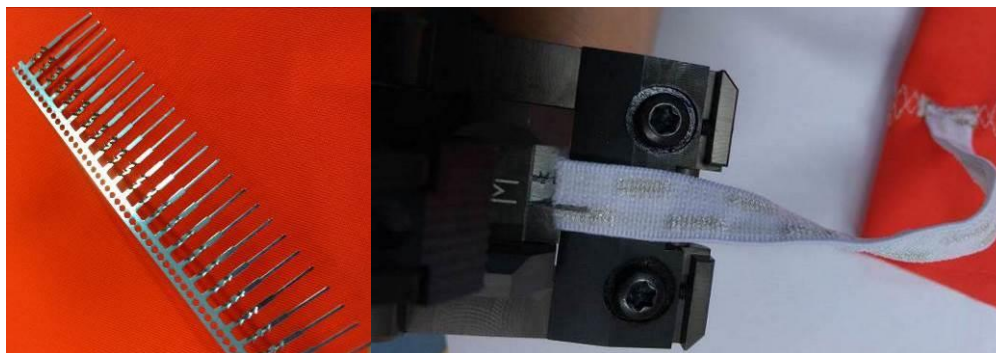
Obr. 53 Crimpflex™ konektory a upevnění krimpů k vodivé stuhě
