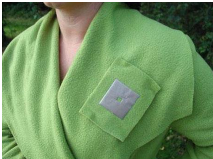
Obr. 7 Mikropásková flíčková (patch) anténa ze vzorované Zelt e-textilie a fleecového substrátu (převzato z [10])
