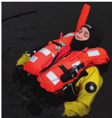
Obr. 18 Testování záchranné vesty s integrovanými textilními anténami (převzato z [35])
