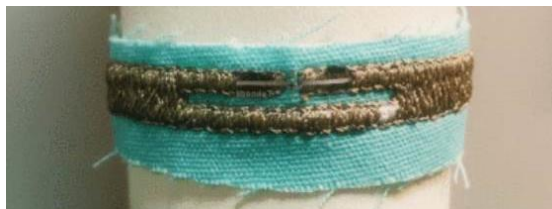
Obr. 36 Vyšítá textilní anténa citlivá na ohyb (převzato z [40])
