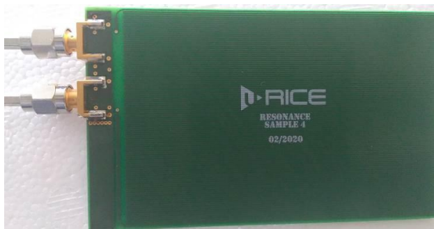
Obr. 76 Planární rezonátor tvořený planární cívkou a SMD kondenzátorem
