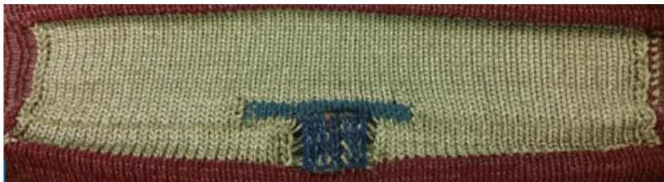
Obr. 27 Pletená anténa v břišním páse (Bellyband) (převzato z [44])
