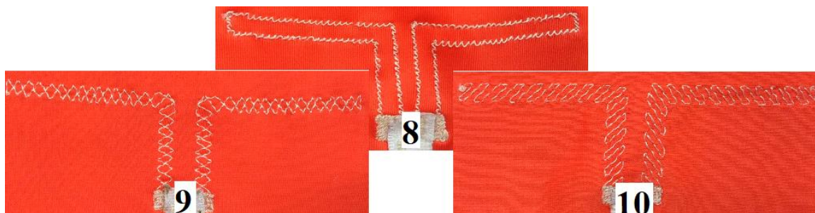
Obr. 51 Vyšíité antény – obyčejný dipól (8 – obrys, 9 – křížení, 10 - meandr)
