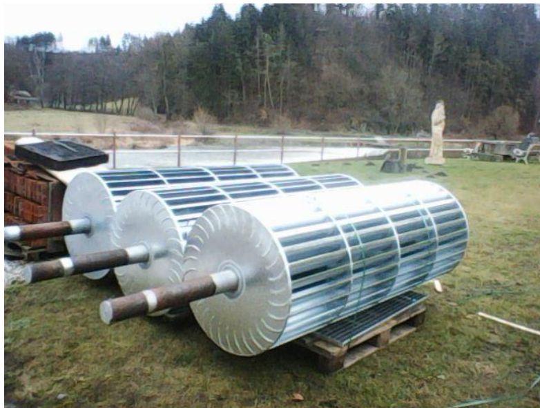
Obr. 1.13 Bánkiho turbína na MVE Nadryby
