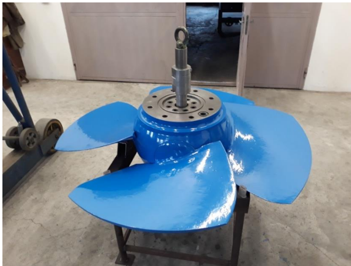
Obr. 1.11 Kaplanova turbína na MVE Nadryby
