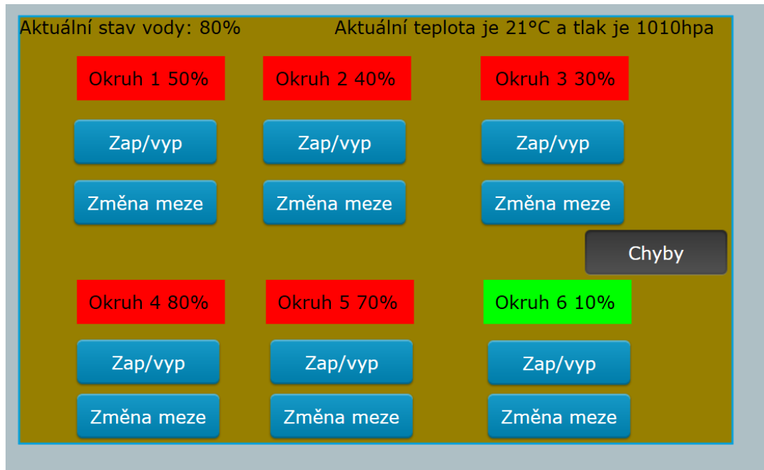
Obrázek 33 - Náhled na hlavní menu řídicí jednotky
