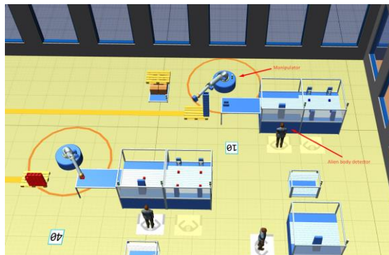
Obr. 10 - návrh implementácie Alien body detector a manipulátora pri procese balenia
