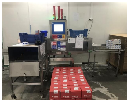
Obr. 2 - Detektor na kontrolu výrobkov ako prevencia prítomnosti nežiaducich telesám
